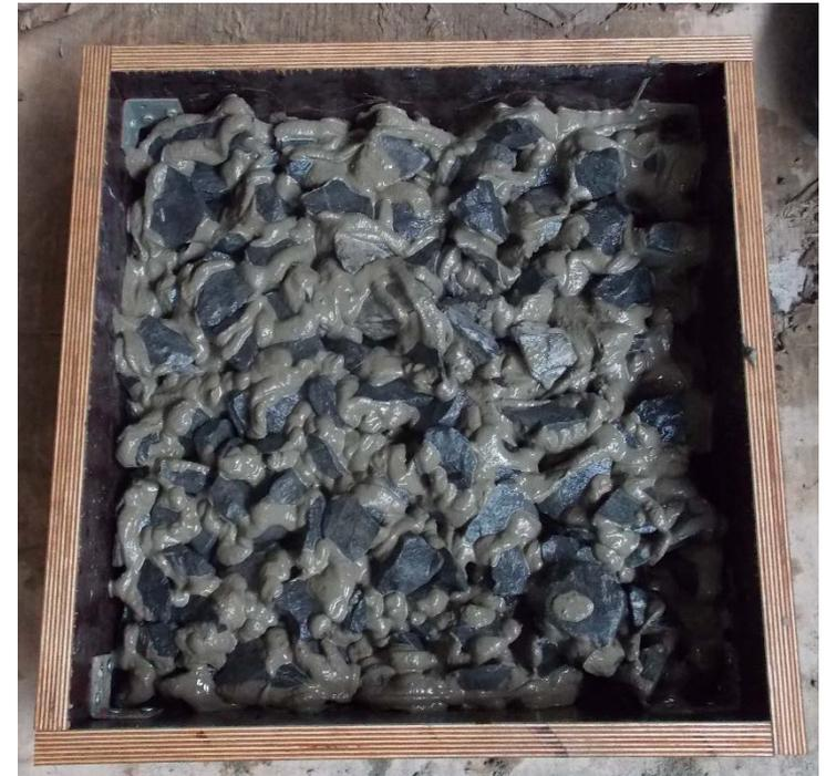
Ziel: Ermittlung der Durchlässigkeit der Deckschicht zur Sicherstellung der Übertragbarkeit der Ergebnisse vom Modell- in den Naturmaßstab
