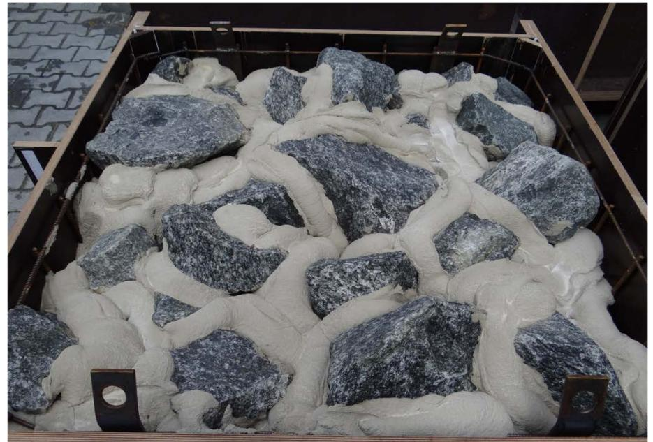
Ziel: Ermittlung der Durchlässigkeit einer Deckschicht aus Steinklasse  $LMB_{5/40}$  bei Variation der Vergussstoffmenge und Deckschichtdicke
