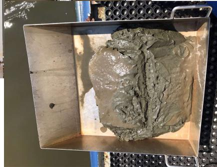
Links: Entnahme von Sedimentproben mit Probennehmer der TUHH; rechts: Entnommene Sedimentproben (gestört und ungestört)
