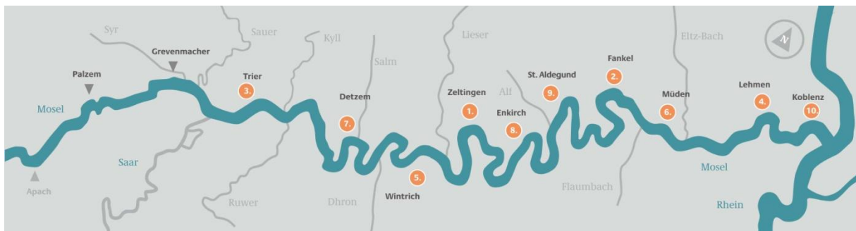
Bild 2: Reihenfolge Bau der zweiten Schleusen an der Mosel
