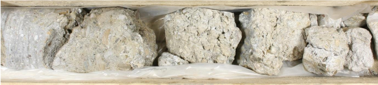
Bild 3: Bohrkerne, die nicht zur Ermittlung von Festigkeitskennwerten geeignet sind
