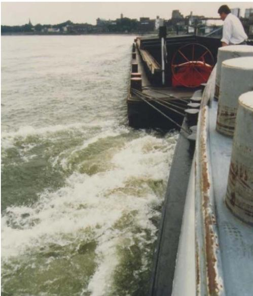
*Bild 3: Wirbelbildung an der Koppelstelle*
