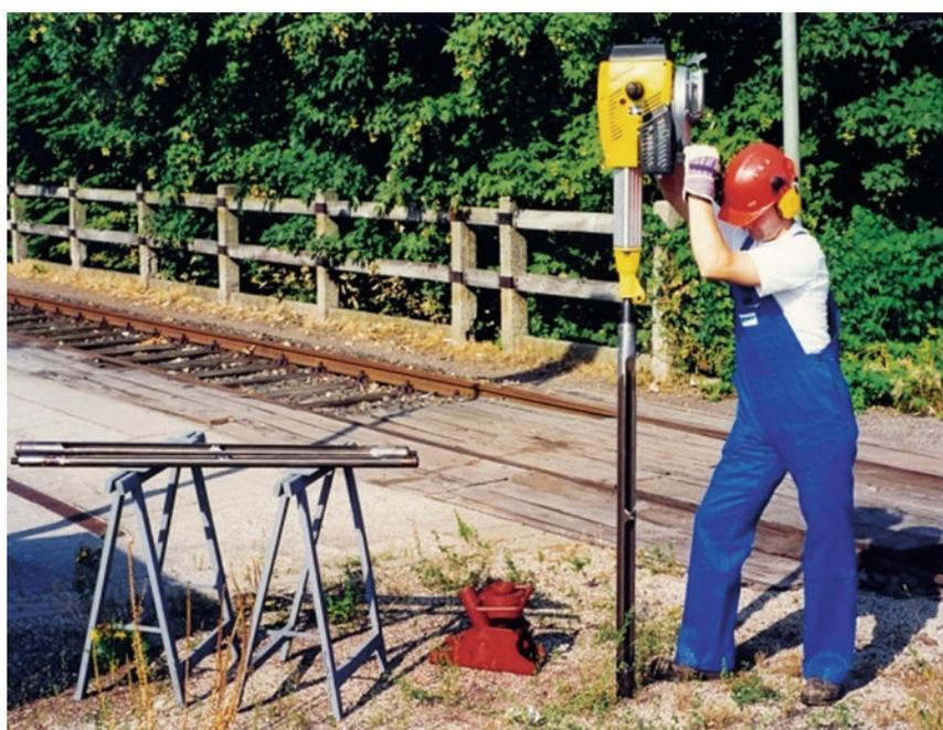
**Abb. 2** Häufig verwendet bei Kleinbohrverfahren: tragbares Kleinrammbohrgerät
