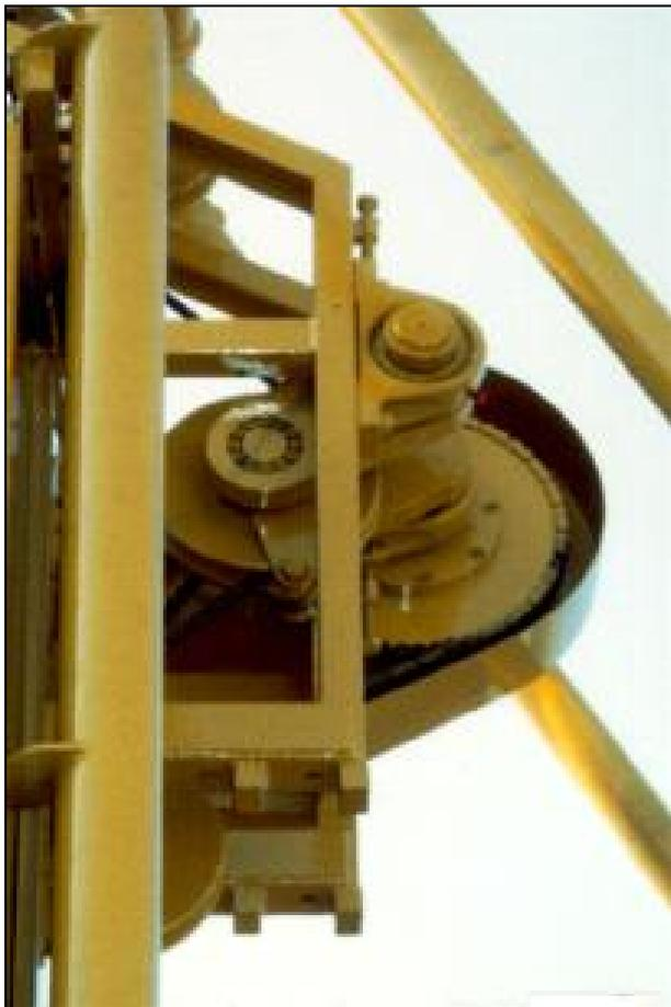
**Bild 10:** Freifall-Seilschlagvorrichtung
