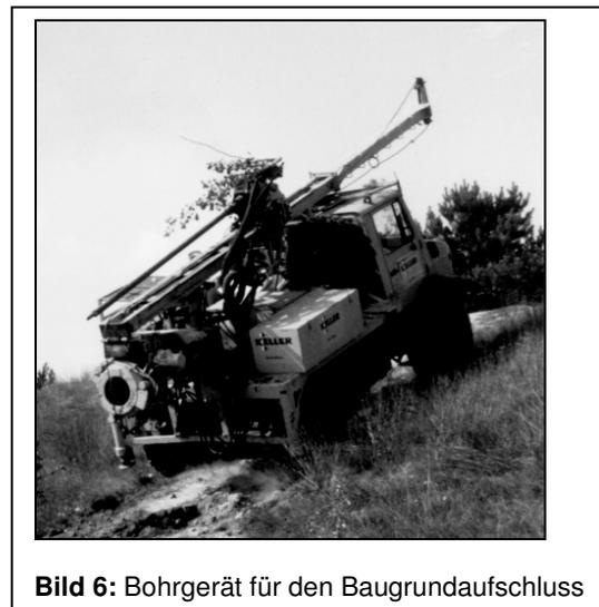
**Bild 6:** Bohrgerät für den Baugrundaufschluss
