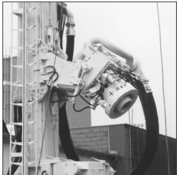
**Bild 12:** Hydraulischer Kraftdrehkopf
