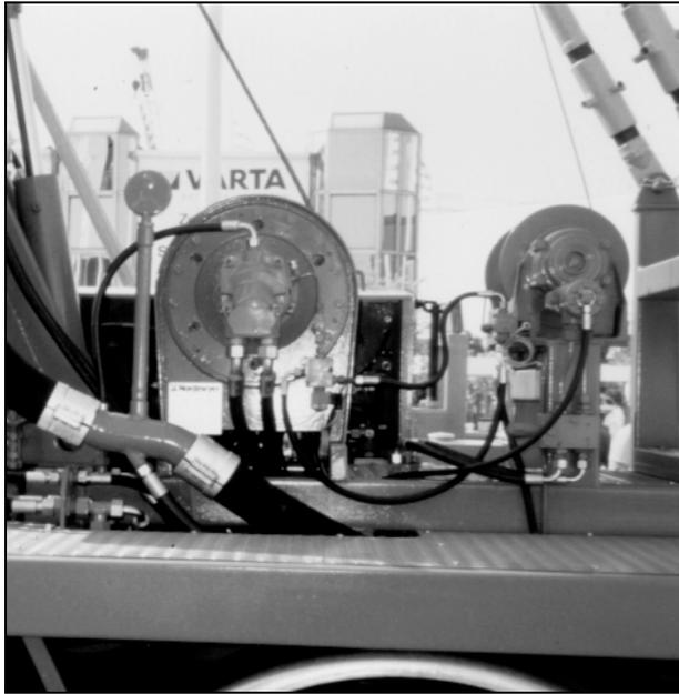
**Bild 9:** Seilwinde und Hilfswinde
