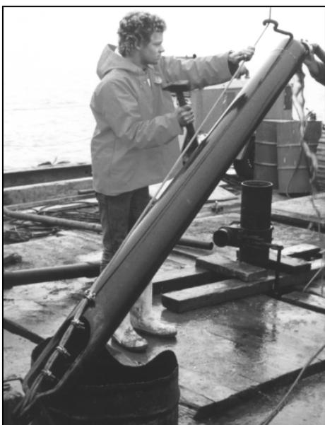
**Bild 18:** Ventilbohrer entleeren
