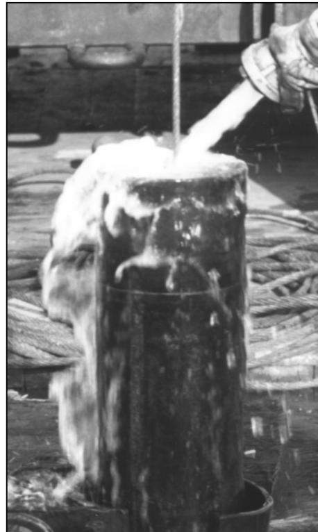
**Bild 16:** Wasserüberdruck aufbringen
