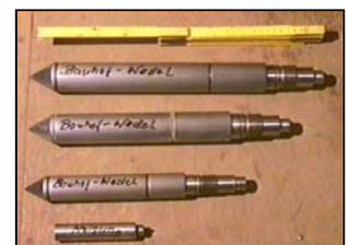
Bild 1: Elektrische Sondierspitzen
