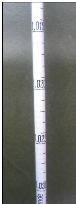
Bild 3: Aräometer mit Detail Ableseskala
