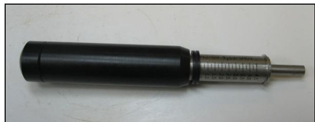
Bild 10: Taschenpenetrometer mit Skalierung
