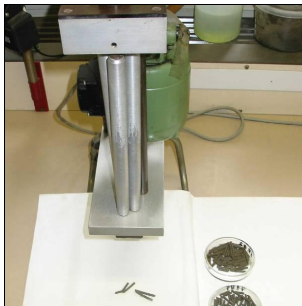
Bild 8: Gerät zur Bestimmung der Ausrollgrenze
