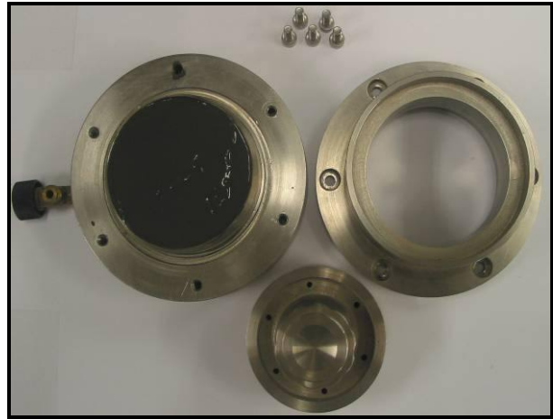
Bild 24: Oedometerzelle des bodenmechanischen Labors der BAW Hamburg
