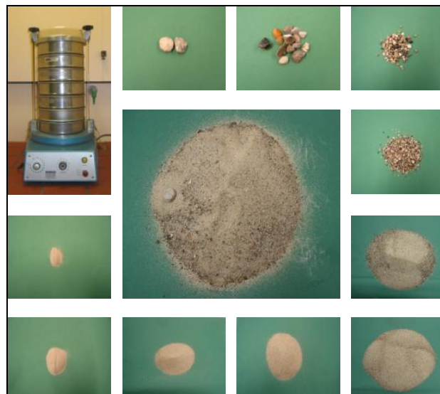
Bild 1 Siebung – Siebmaschine und Kornfraktionen
