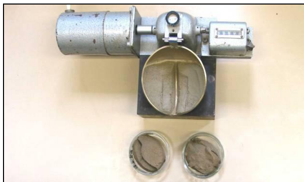
Bild 7: Fließgrenzengerät nach Casagrande
