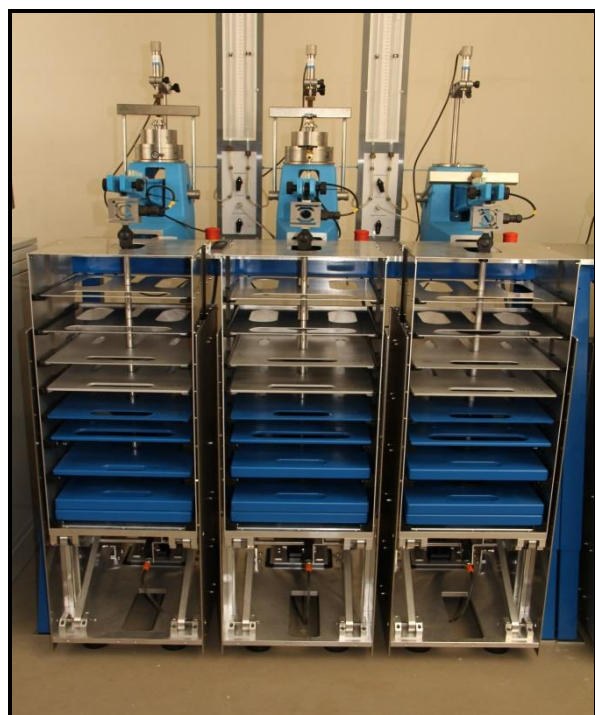
Bild 25: automatisierter KD-Stand des bodenmechanischen Labors der BAW-Hamburg
