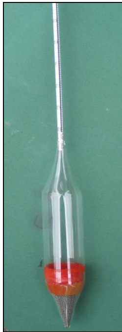
Bild 3: Aräometer mit Detail Ableseskala
