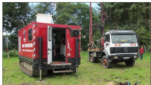
**Bild 8:** Drucksondierung (links) und verrohrte Trockenbohrung (rechts), Schinkel 2016.
