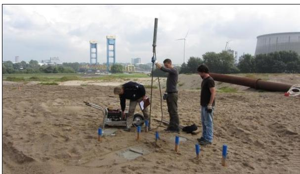
**Bild 5:** Sondierung mit der Leichten Rammsonde, Spülfeld Ellerholz 2013
