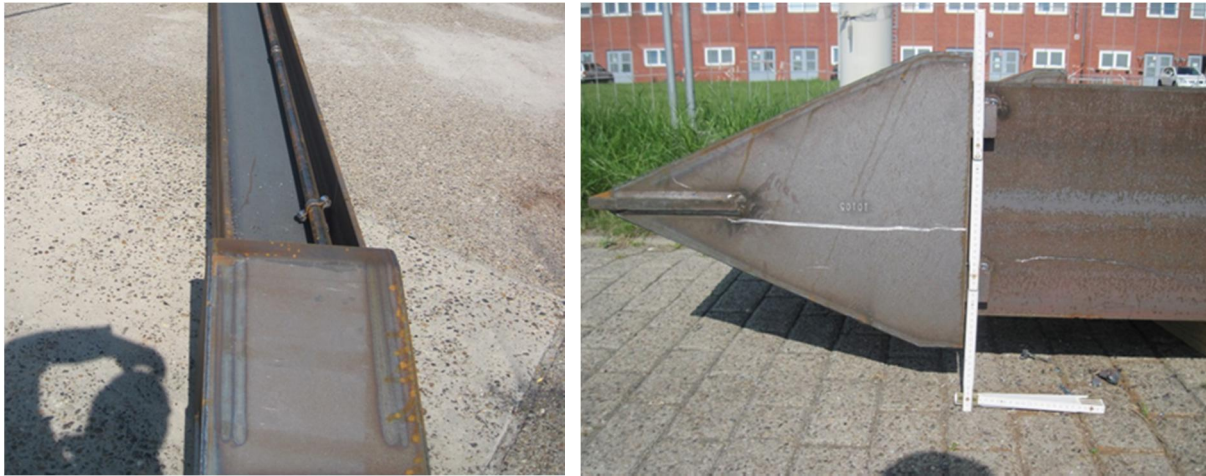
Bild 7: VM-Pfahl, Pfahlschuh (Drauf- und Seitenansicht)
