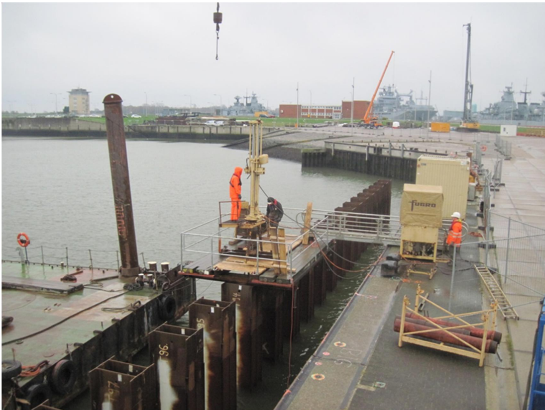
Bild 10: Durchführung CPT im Bereich der Tragbohlen
