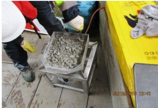
*Bild 6: Frischbetonprüfung, Darrversuch
