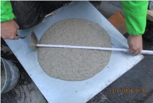
*Bild 5: Frischbetonprüfung, Ausbreitmaß
