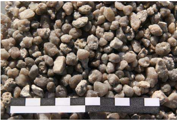
Bild 1: Quarzkies, Körnung 5,6 – 8,0 mm gemäß DIN 4924
