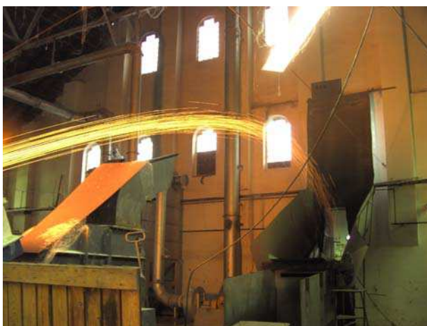
Bild 4: Abkühlen der Kugelschmelze im Flug
