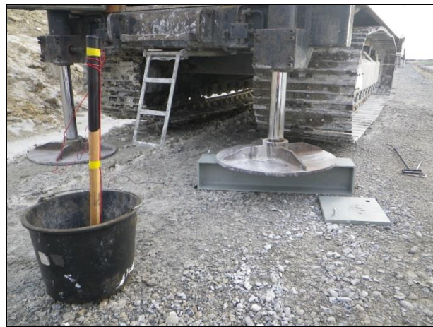
Bild 7: Versuchsaufbau des SCPT-Verfahrens (Fugro Consult, 2017)
