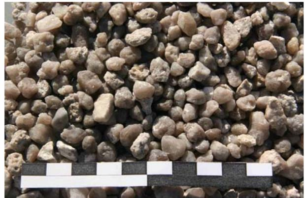
**Bild 4:** Haufwerk eines locker gelagerten Filterkieses  $5,6$  bis  $8\text{mm}$ . Foto: Fa. Ochs, Nürnberg
