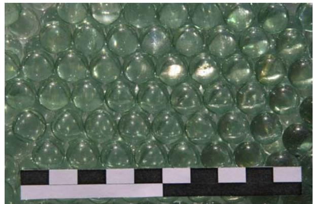
**Bild 5:** Haufwerk von Glaskugeln  $6 \text{ mm}$  in dichter Lagerung. Foto: Fa. Ochs, Nürnberg
