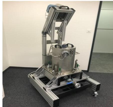
*Abbildung 2: Versuchsaufbau gemäß ASTM C1138.*
