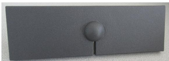
Abbildung 4: Beschichteter Prüfkörper mit Nietkopfschraube zur Verfahrensvalidierung
