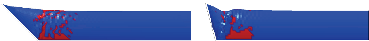
Bild 7: Verteilung der ersten 1.Hauptspannung in der Membran bei unterschiedlicher Wangenneigung: \gamma = 45^\circ (links) und \gamma = 75^\circ (rechts)
