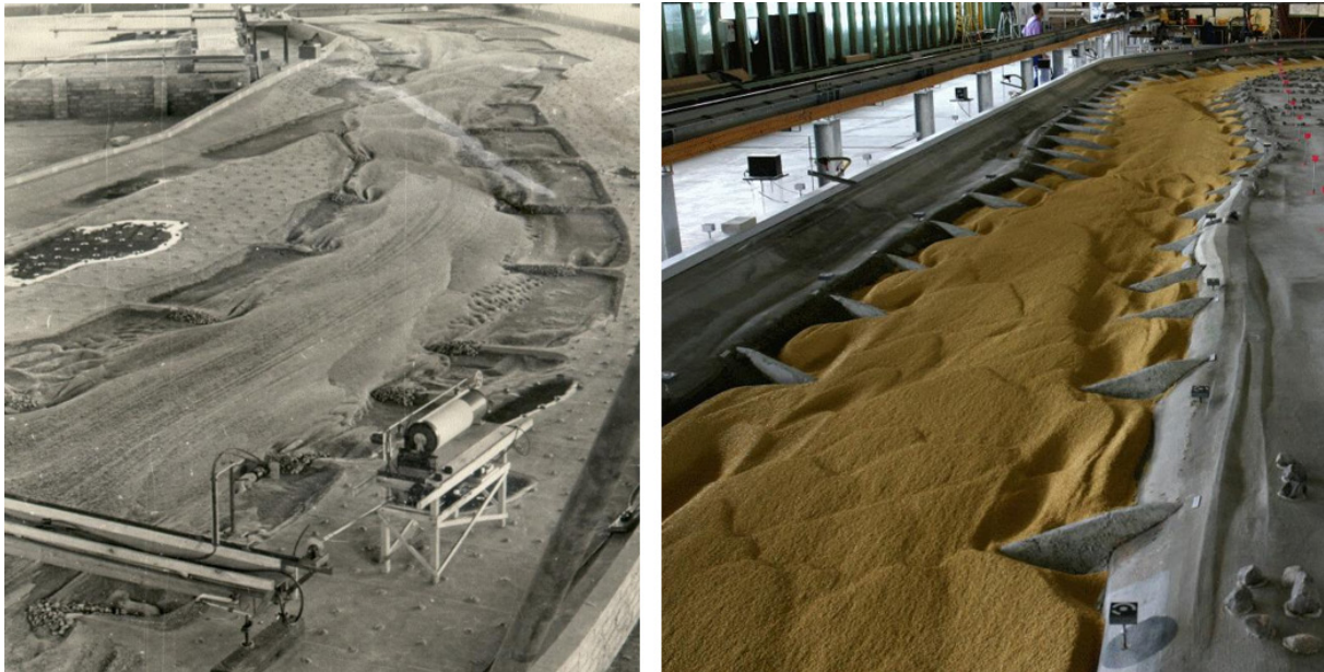
Abbildungen 15 und 16: Flussmodelle mit beweglicher Sohle. links in den 1960er Jahren mit einem überhöhten Gefälle ("Berliner-Methode" in der FAS in Berlin, HB23602), rechts mit einem leichten Kunststoffgranulat (Polystyrol) als Modellsediment, Modell der Oder bei Hohenwutzen in den 2010er Jahren in der BAW in Karlsruhe
