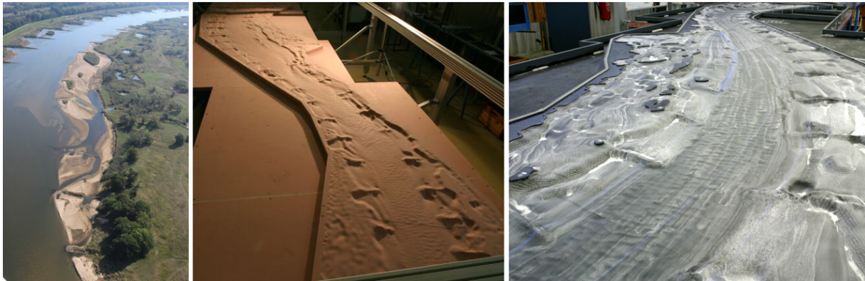
Abbildungen 6, 7 und 8: Links Naturaufnahme der Oder bei Reitwein, Mitte: Luftmodell dieses Flussabschnittes als 3D-Fräsmmodell, rechts Sichtbarmachung der Sohlstromlinien durch ein Anstrichverfahren in dem Modell. Links und Mitte mit Blick gegen die Fließrichtung, rechts mit Blick in Fließrichtung
