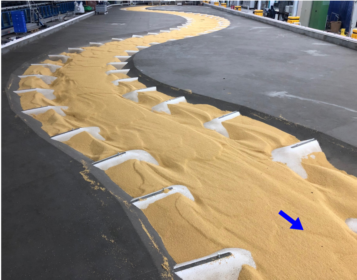
Abbildung 1: Aktuelles Krümmungsmodell der BAW zur Untersuchung der Hydraulik und Morphologie in Flüssen mit Geschiebetransport und Regelungsbauwerken (BAW)
