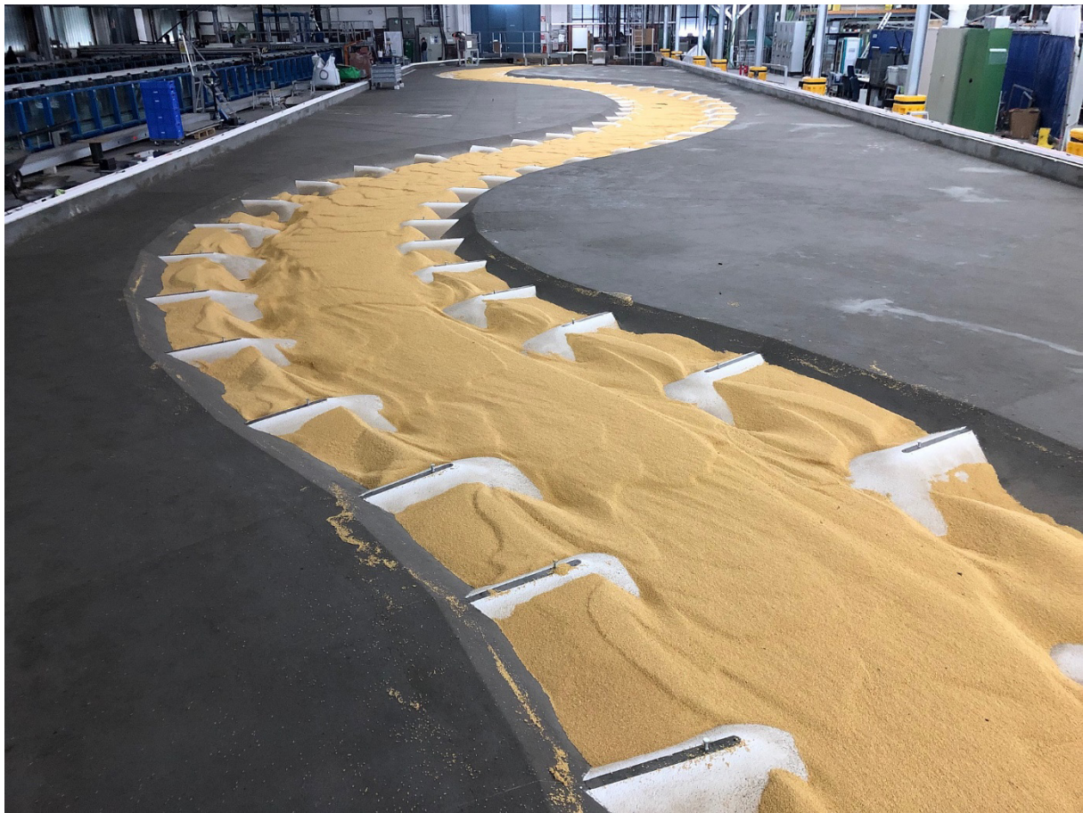
Abbildung 3: Labormodell der BAW zur prinzipiellen Untersuchung morphologischer Prozesse in Flusskrümmungen
