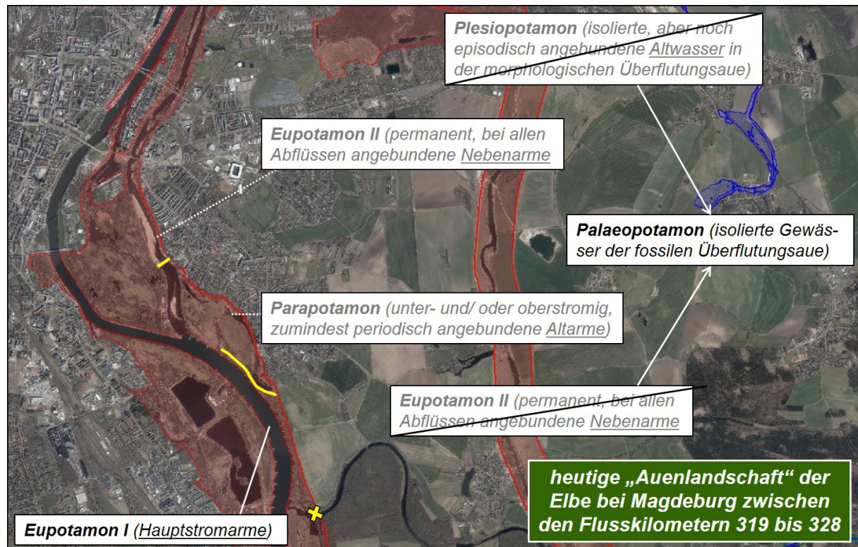
Abbildung 2: Altgewässertypen – aktuelle Bestands- und Anbindungssituation in der Elbaue bei Magdeburg (Quelle: Landesamt für Vermessung und Geoinformation Sachsen-Anhalt, Cardo-GIS des LHW)
