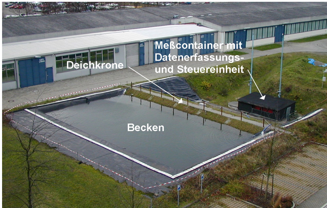
Bild 7: Naturmaßstäbliches Deichmodell auf dem Gelände der Bundesanstalt für Wasserbau (BAW) in Karlsruhe während eines Einstauversuches im Dezember 2000 (Zustand stationärer Durchströmung)
