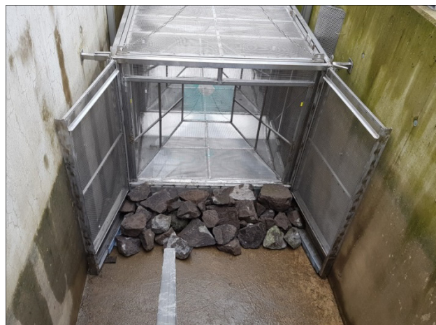
Abb. 3: Einbau des Prototyps der Standardreuse in einem speziellen Zählbecken einer FAA zur Bestimmung der Fängigkeit (Fotos: BfG)
