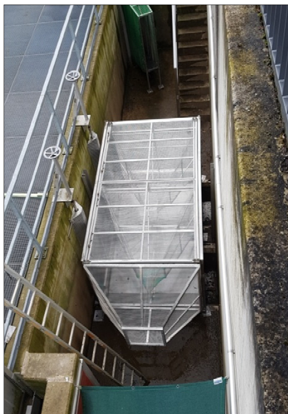
Abb. 3: Einbau des Prototyps der Standardreuse in einem speziellen Zählbecken einer FAA zur Bestimmung der Fängigkeit (Fotos: BfG)
