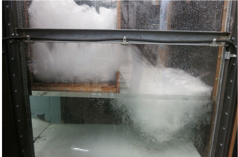
Bild 9: Hydraulische Modellversuche Energieumwandlungsschacht am IWG, KIT Karlsruhe
