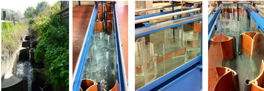
Abb. 4: Links: physikalisch modellierte Becken der FAA Rothemühle, mittig links bzw. mittig rechts: Froude-Modell M 1:4,6 im Labor, rechts: Geschwindigkeitsmessung Schlitz; (Fotos: TU Dresden, IWD)
