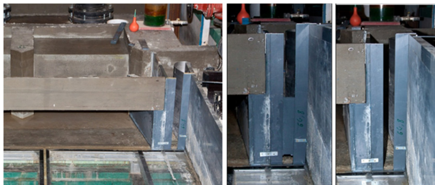
Abb. 6: Typ „B“ im physikalischen Modell mit Einstiegsöffnungen und durchgehendem Schlitz
