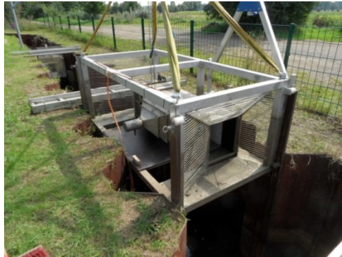
Abb. 4: Vaki-Counter im gehobenen Zustand (Foto: Mockenhaupt, BfG)
