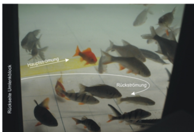
Abb. 6: Aufbau des ethohydraulischen Versuchsstandes zur Untersuchung der Schlitzzpassierbarkeit für leistungsschwache Fischarten am Karlsruher Institut für Technologie (oben und Mitte links). Aus den gewonnenen Fließgeschwindigkeitsdaten konnten durch Verschneidung mit fischartenspezifischen Leistungsdiagrammen (unten rechts) ethohydraulische Diagramme zu den Strömungssignaturen im Schlitzbereich erstellt werden (Mitte rechts). Das beobachtete Verhalten der Fische bestätigte die Richtigkeit und Verwendbarkeit der so aus Messwerten abgeleiteten Diagramme (Foto links unten).
