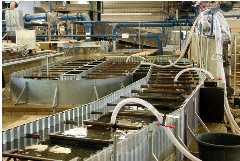
Abb. 4: Physikalisches Modell (Maßstab 1:13) eines Doppel-Schlitzpasses mit zwei 180°-Umlenkbecken und einer 20°-Krümmung.
