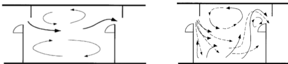
Abb. 3: Strömungssignaturen in Schlitzpässen: flow pattern I (links), flow pattern II (rechts) (Quelle: WU et. al 1999)
