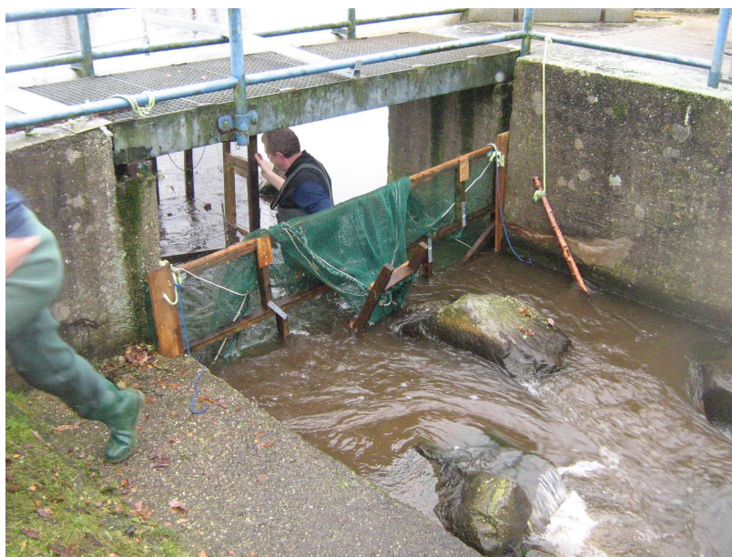
Abb. 8: Die Fangeinrichtung (Rahmen - Fangtrichter - Fangkammer) in Bollingerfähr/Ems. Nach der Bergung des Fanges wurde die Fangeinrichtung wieder fängig gestellt (Aufsetzen auf die Sohle).
