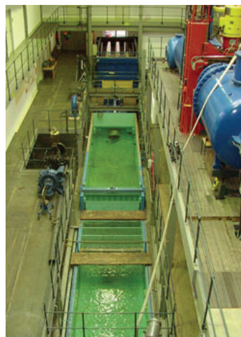
Bild 3 a, b: Niederdruckversuchsstand der Versuchsanstalt München Zentrum des Lehrstuhls für Wasserbau und Wasserwirtschaft der TU München (Quelle: TU München)
