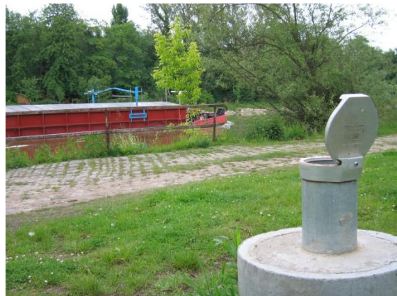
Bild 1: Geöffnete Grundwasser-Messstelle an einer Bundeswasserstraße
