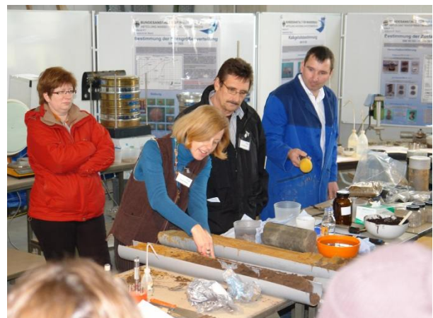
Bild 1: Bearbeitung eines geöffneten Kernliners (BAW-Baugrundkolloquium 2008)
