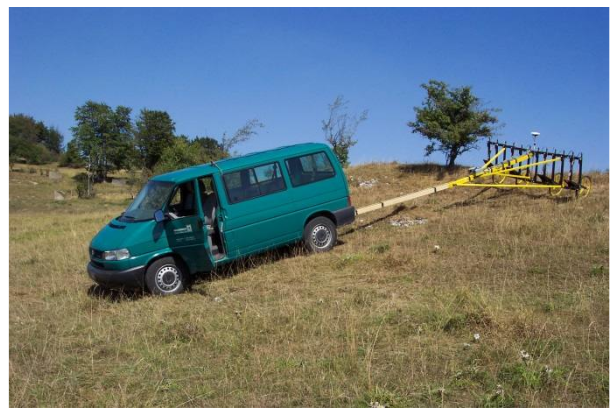
Bild 5: GPS gesteuertes Sondenarray im Einsatz Quelle Schollenberger 2011
