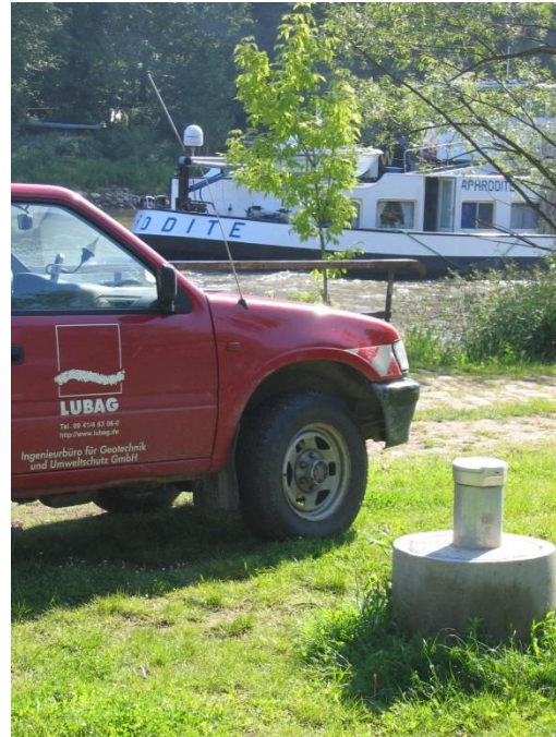
Bild 2: Grundwasser-Messstelle in der Talaue einer Bundeswasserstraße
