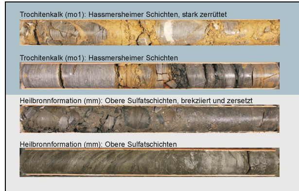
Bild 4: Gegenüberstellung von Bohrkernen in weitgehend ungestörtem Fels und in stark gestörten und verwitterten Gesteinen (Fotografische Aufnahmen durch BAW Karlsruhe)
