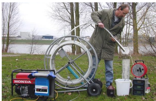
Bild 2: Qualifizierte Grundwasser-Probenahme mittels Unterwassermotorpumpe (U-Pumpe)
