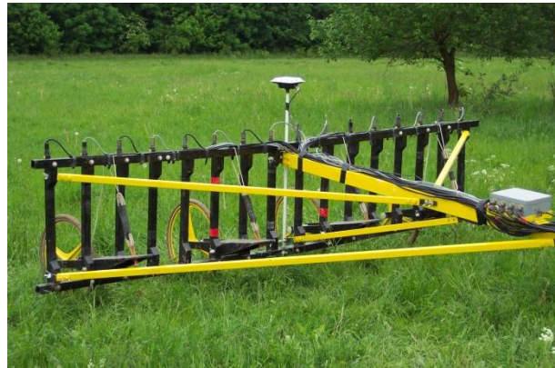
Bild 4: GPS gesteuertes Sondenarray im Einsatz Quelle Schollenberger 2011
