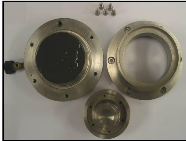
Bild 24: Oedometerzelle des bodenmechanischen Labors der BAW Hamburg
