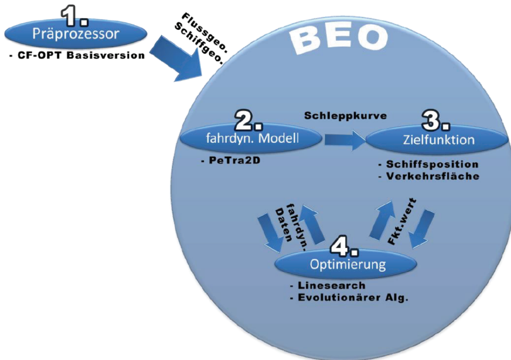
Bild 2: Programmstruktur des fahrdynamischen Optimierungsverfahrens
