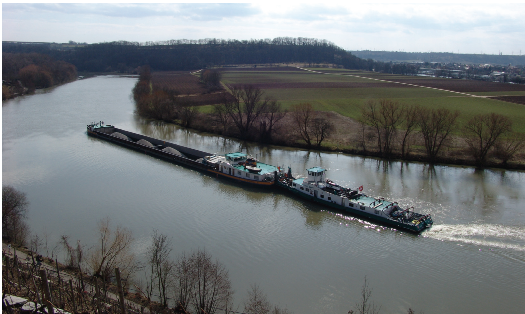
Bild 1: Versuchsverband bestehend aus dem SSB Vogel Gryff (34,85 m x 7,0 m) und dem GMS Hanna Krieger (105 m x 10,5 m x 2,7 m)
