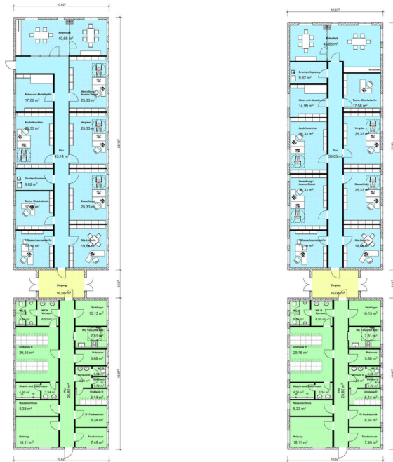
Bild 17: unterschiedliche Möglichkeiten der Modul- und Raumanordnung bei gleichbleibender Hüllfläche
