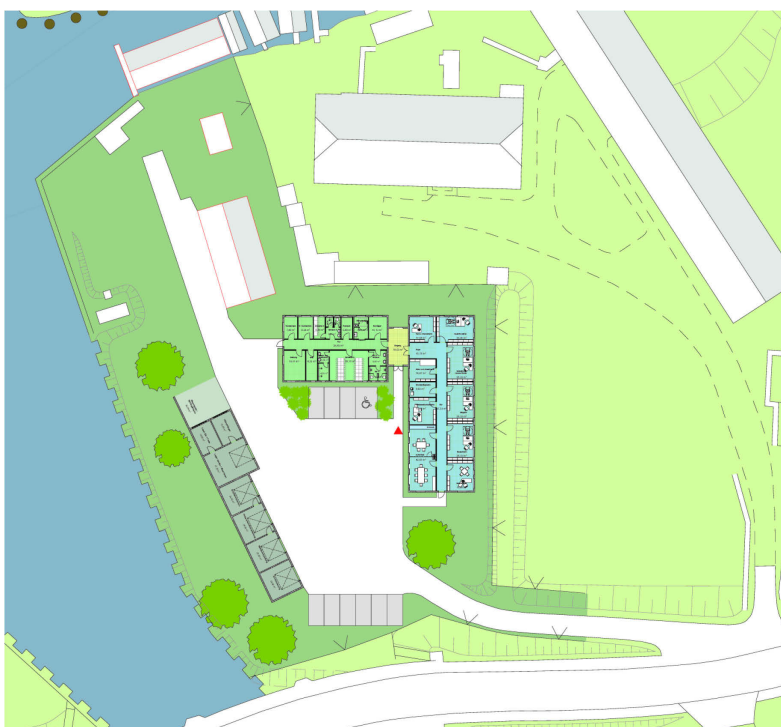
Bild 15: Die Modul-Anordnung aus Bild 9 wird in ein trapezförmiges Beispielgrundstück eingesetzt, Büro-Modul an der Flucht ausgerichtet.
