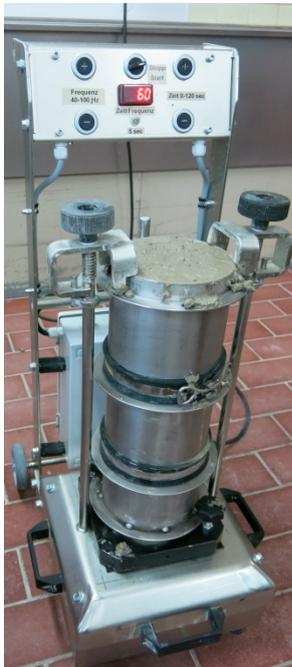
Bild 3: Verdichtungsgerät mit eingespannter, mit Beton gefüllter Zylinderform
