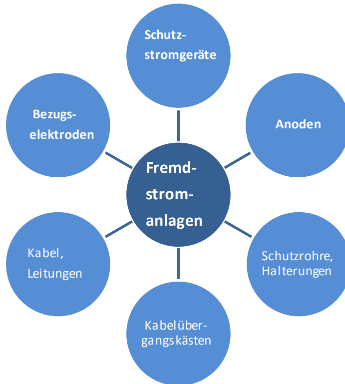
Bild 1: Aufstellung wesentlicher Bauteile von Fremdstromanlagen
