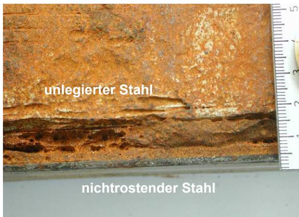
*Bild 4: Korrosion am unlegierten Stahl infolge einer Aufplattierung aus nichtrostendem Stahl*
