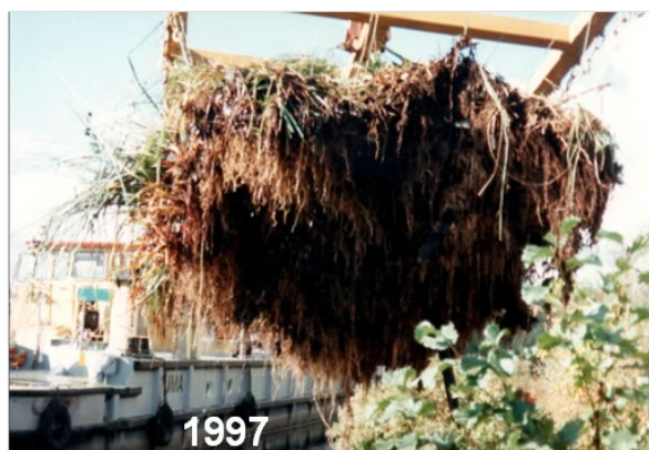
Zugversuch: Nachweis der sehr guten Durchwurzelung bis in den Untergrund hinein – 3 Jahre nach Einbau (große Kräfte erforderlich, um die KDW anzuheben) (Quelle: BAW)
