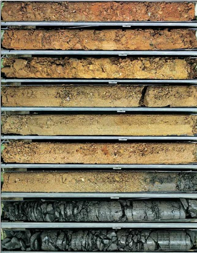
Bild 3: Charakteristische Schichtenfolge im Baufeld der Weserschleuse
