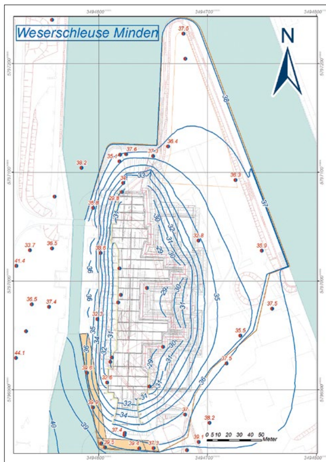
Bild 21: Im Endaushub gemessene (Symbole) und berechnete Grundwasserstände (Quelle: BAW)
