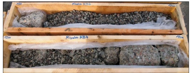
Bild 5: Kernproben aus einem Probebohrpfahl aus Dränbeton
