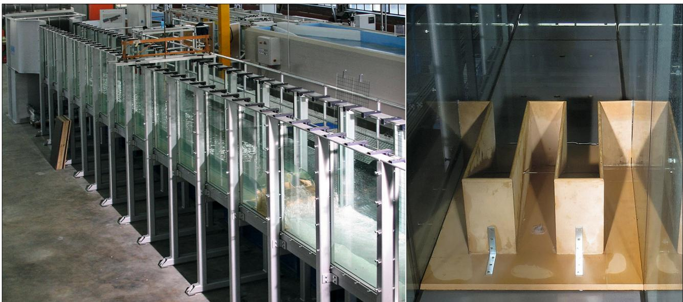
Bild 2: Links: Versuchsrinne, rechts: rechteckförmiges Labyrinth-Wehr-Modell
