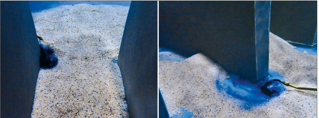
Bild 12: Strömungsvisualisierung des Hufeisenwirbels mit einem Tracer: Blick aus dem Inlet-Key entgegen der Strömungsrichtung (links) und in Strömungsrichtung auf die Stirnseite des Outlet-Keys (rechts)
