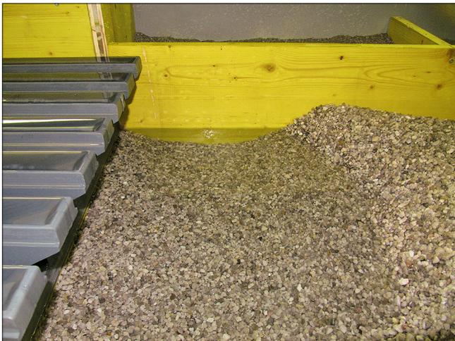
Bild 6: Kolkloch und Ablagerung im Unterwasser eines PKW in den Versuchen von Jüstrich et al. (2016)
