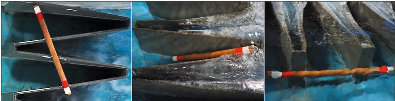
Bild 7: Verkläusungsbilder: Ablegen auf der Wehrkrone (links), Ablagern im Wehr (Mitte) und Querstellen vor dem Wehr (rechts)
