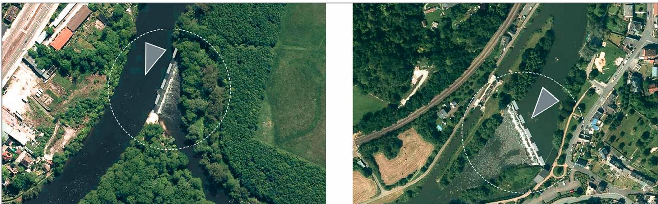
Bild 2: Beispiele für ein gerades Streichwehr (links: Kleines Wehr Böllberg an der Saale) und für ein schiefes Streichwehr (rechts: Villmar an der Lahn)
