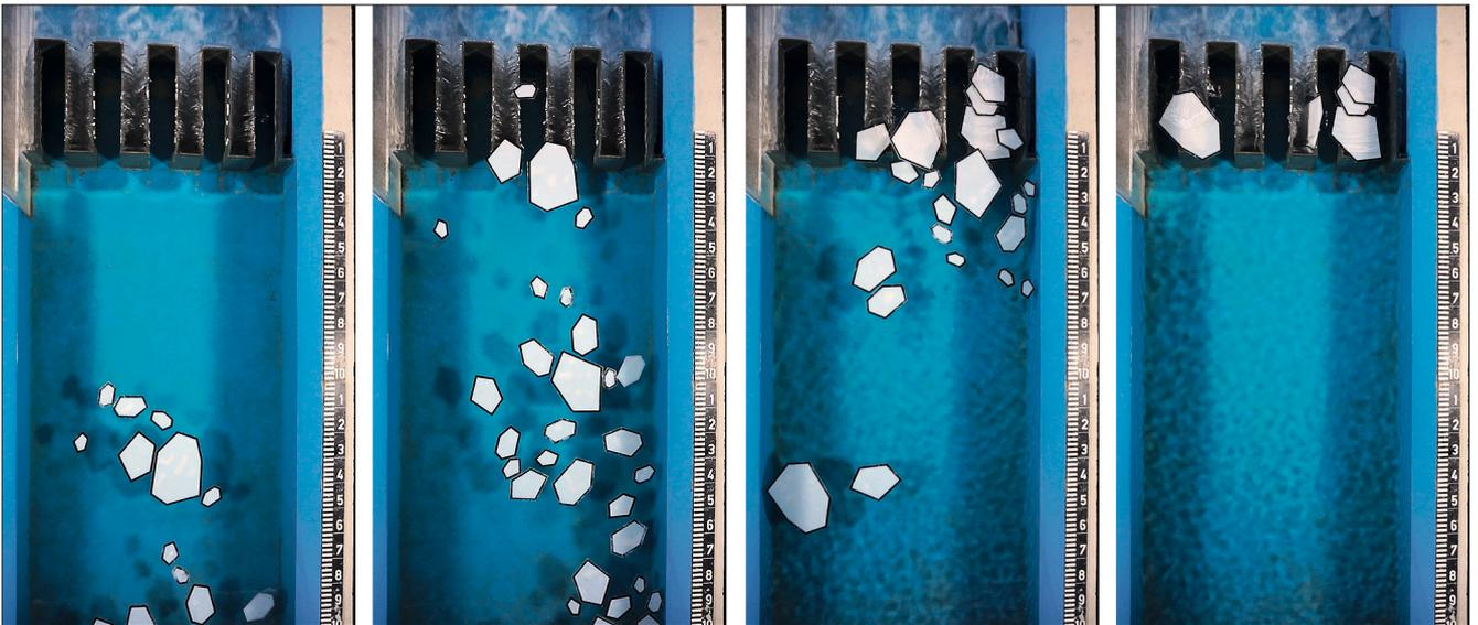
Bild 10: Zeitlicher Verlauf der Treibeisversuche bei einem spezifischen Abfluss von  $0,048 \text{ m}^2/\text{s}$  beim rechteckförmigen Labyrinth-Wehr
