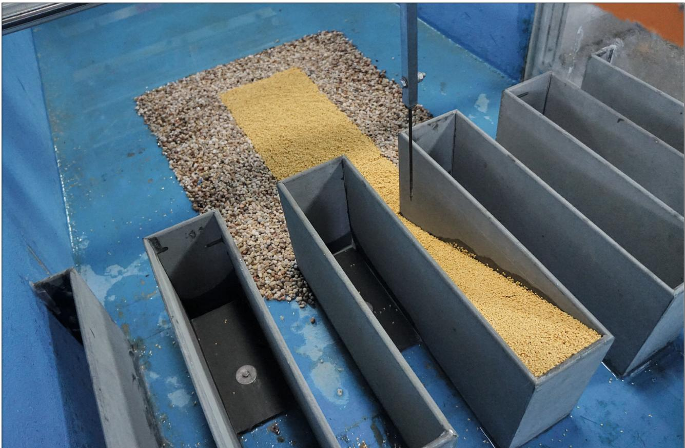
Bild 4: Rampenförmige Sedimentablagerung zu Beginn der Versuche, Spitzentaster zur Aufnahme der Sedimentoberkante, Sedimentschicht vor dem Inlet-Key als Referenz für den Bewegungsbeginn des Sediments im Oberwasser
