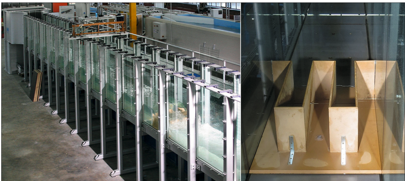
Bild 2: Links: Versuchsrinne, rechts: rechteckförmiges Labyrinth-Wehr-Modell
