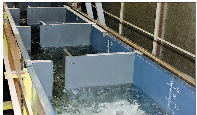
Bild 4: Gegenständliches Modell des Schlitzpasses im Theodor-Rehbock-Wasserbaulaboratorium des IWG (Höger et al. 2015a)
