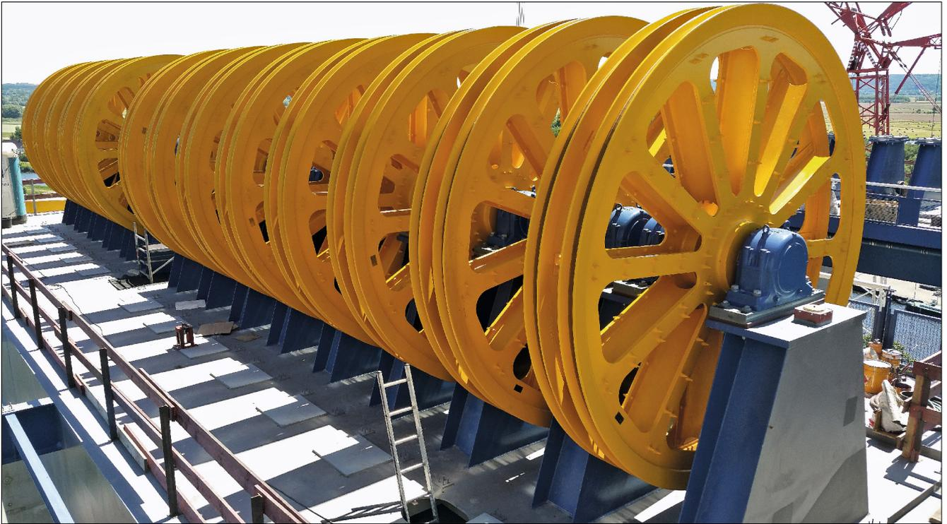
Bild 4: Montierte Doppelseilrollen in der noch nicht montierten nordöstlichen Seilrollenhalle (Quelle: SIEMAG TECBERG GmbH)
