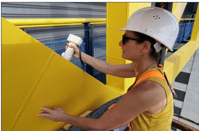
Bild 4: Bestimmung der Farbtongenauigkeit am SHW mittels Krankorb durch eine Mitarbeiterin der BAW
