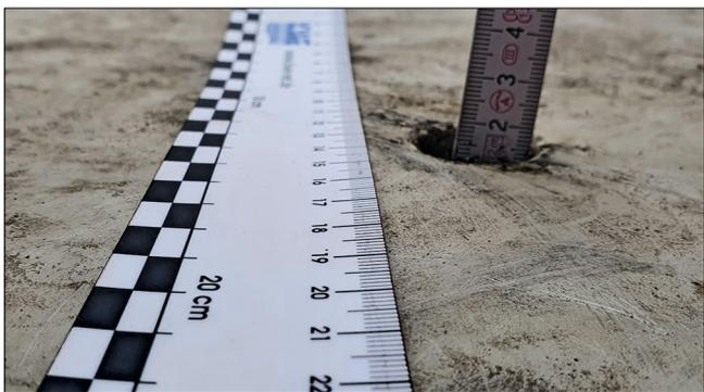
Bild 6: Zu tief eingebaute Messelektroden
