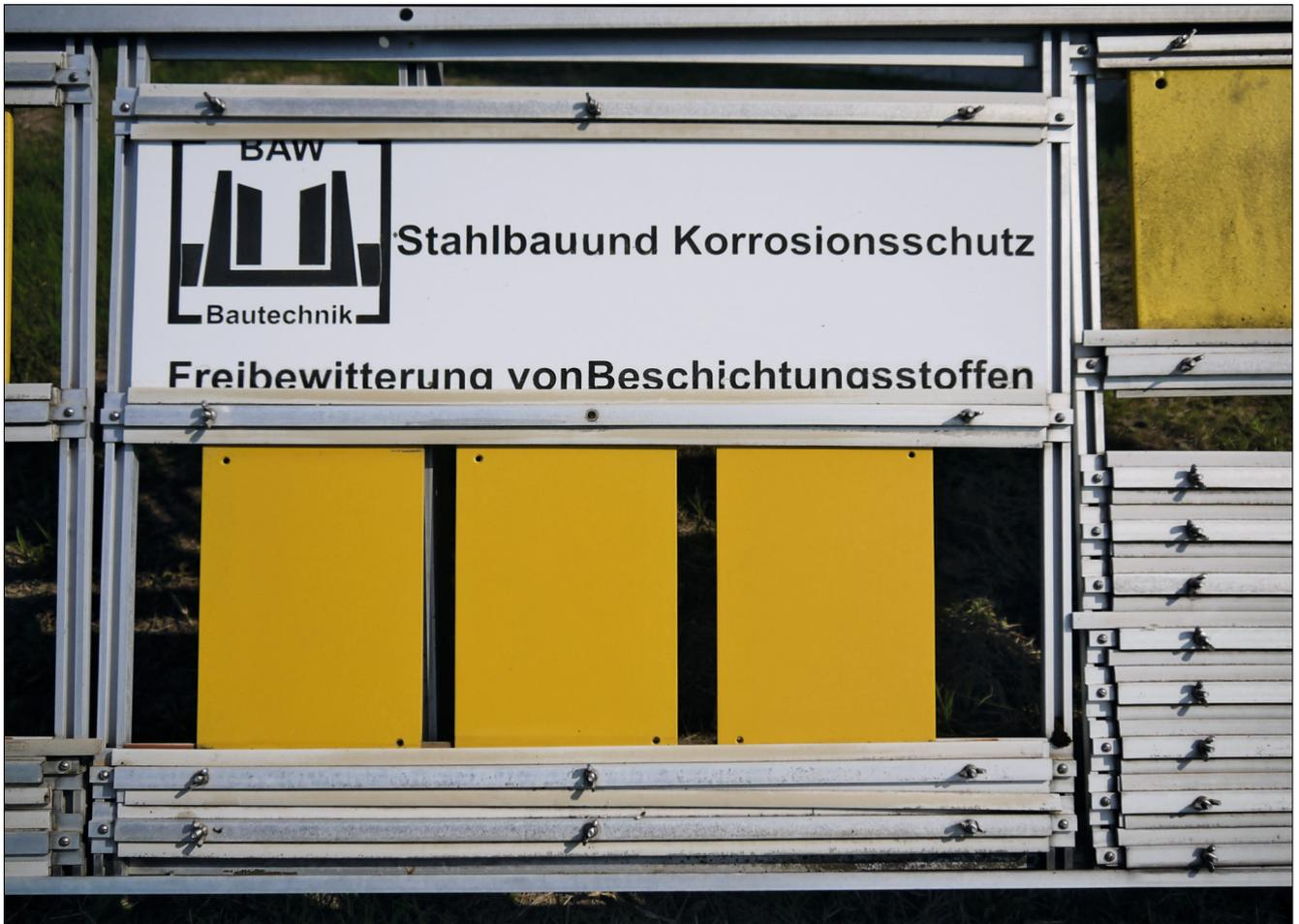
Bild 2: Naturauslagerung bei der BAW in Karlsruhe
