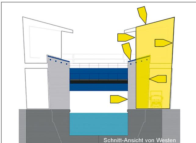
Bild 21: Das Sicherheitstor übernimmt die Geometrie der Seilrollenhallen und Stützen.
