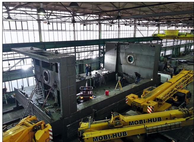
Bild 10: Werkstattfertigung – Vormontage Trogtormulde
