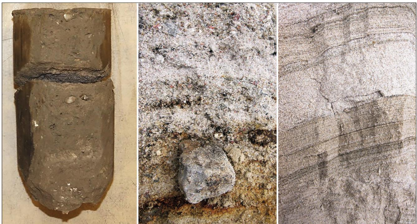
Bild 2: Böden der glazialen Serie (links: Geschiebemergel; Mitte: Schmelzwassersand; rechts: Beckensand)
