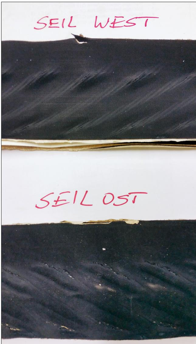
Bild 7: Verformungen und Einrisse in den Elastomeren nach dem Lasteintrag durch die Seile (Quelle: SIEMAG TECBERG GmbH)
