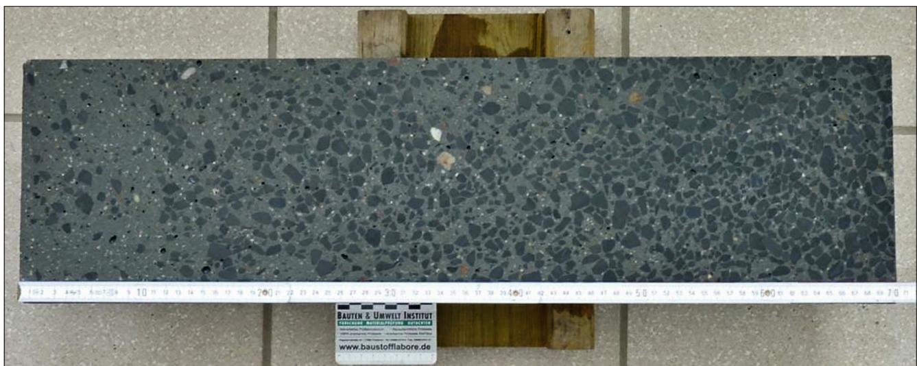
Bild 8: Ungleichmäßige Verteilung der groben Gesteinskörnung infolge Absetzen (links Einfüllseite beim Betonieren) (Quelle: Prüfbericht Bauten & Umwelt Institut)
