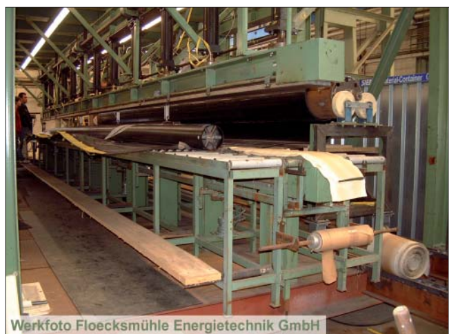
Bild 5: Vulkanisation einer Verbindungsnahtheilung
