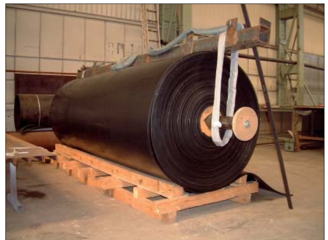
Bild 4: Schlauchmembranrolle vor Zuschnitt
