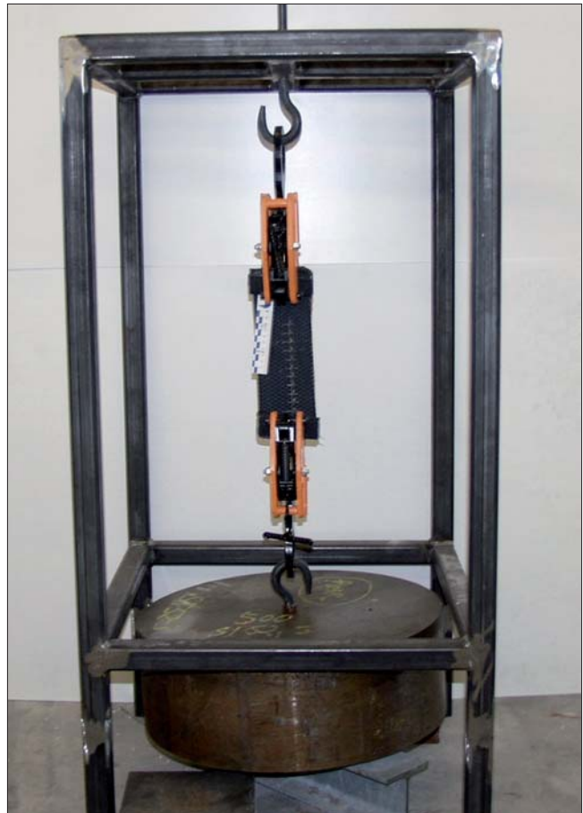
Bild 15: Kleiner Versuchsstand Langzeitversuch mit Probe und Messmarkierungen
