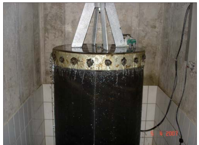
Bild 9: Überlauf am Steuerbalg
