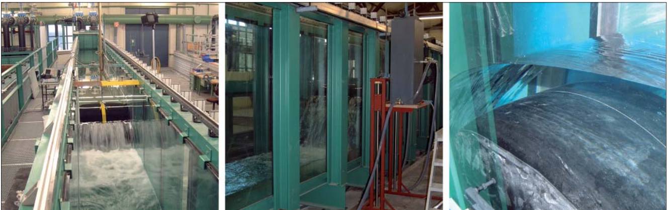
Bild 3: Ausschnittmodell im Maßstab 1:5 in der Versuchsrinne: links) Blick vom Unterwasser, Mitte) Regulierungsschacht, rechts) seitliche Dichtungsflächen
