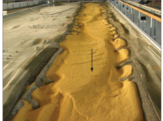
Bild 4: Alternierende Kiesbänke (Modell Oder Hohenwutzen)
