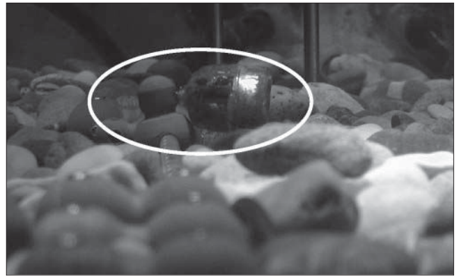
Bild 19: Drucksensor an der Sohle (Detert et al., 2004)
