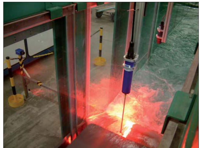
Bild 16: 0,80-m-Rinne mit eingebautem Absturz, LED-Licht, Messsonden und Highspeed-Kamera
