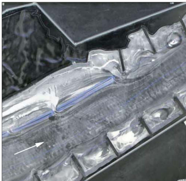
Bild 17: Oder bei Reitwein-Kietz: Erosionsverfahren – Bereich am Ende des Parallelwerks, Bauwerke umströmt
