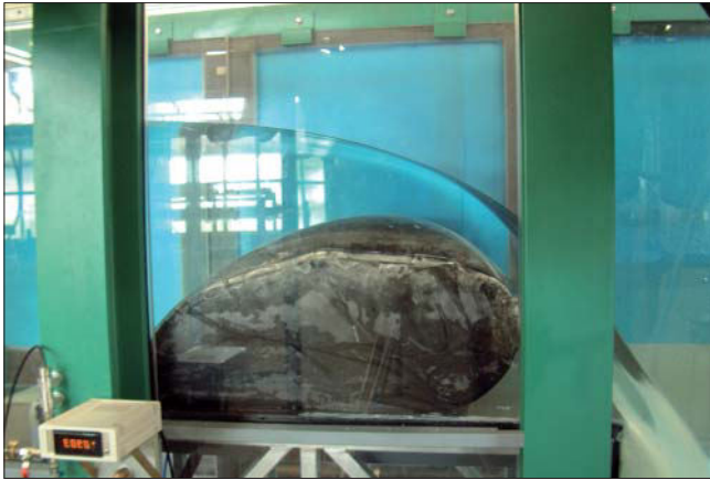
Bild 14: Überströmtes Schlauchwehr in der 0,80-m-Rinne
