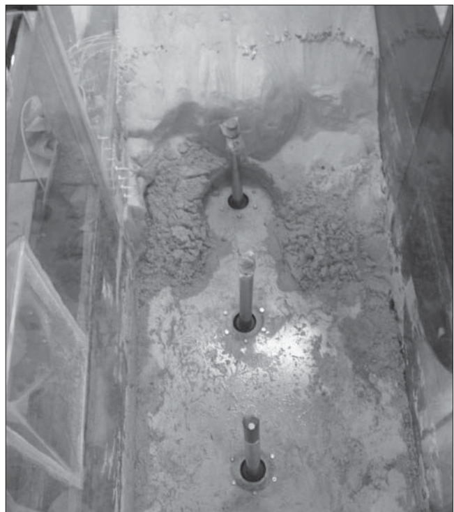
Bild 26: Am Rinnenboden montierte Endoskopreihe für die Bewegungsdetektion an der Grenzschicht Sand/Kies
