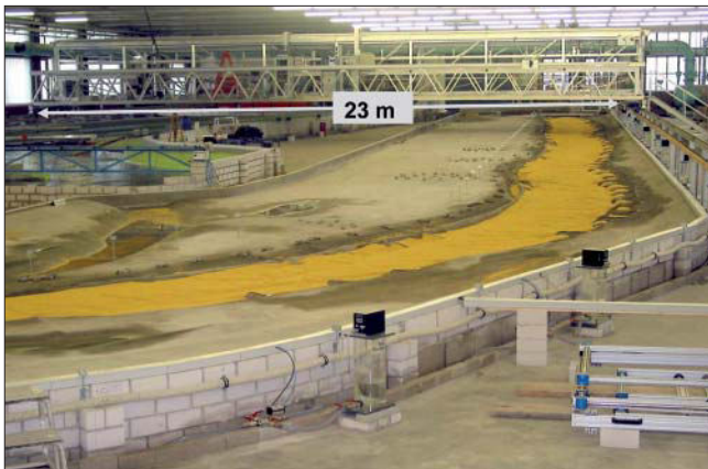
Bild 22: Übersicht Oder-Modell Hohenwutzen mit Messbrücke im Hintergrund
