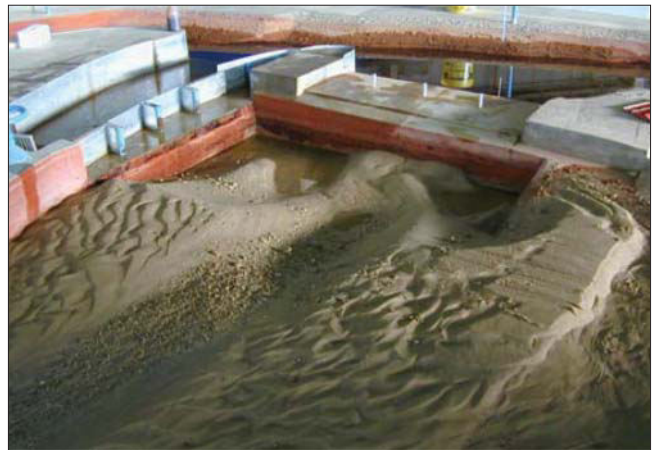
Bild 1: Kolkprozess im Unterwasser der Wehranlage Döhrener Wolle, Hannover, physikalisches Modell mit beweglicher Sohle, LWI, 2002
