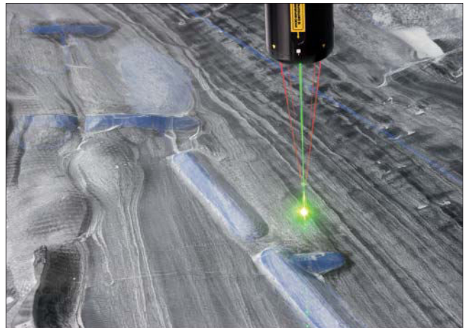
Bild 22: Strömungssichtbarmachung mit Erosionsverfahren und Laser (LDA) – Fotomontage ohne Deckplatte
