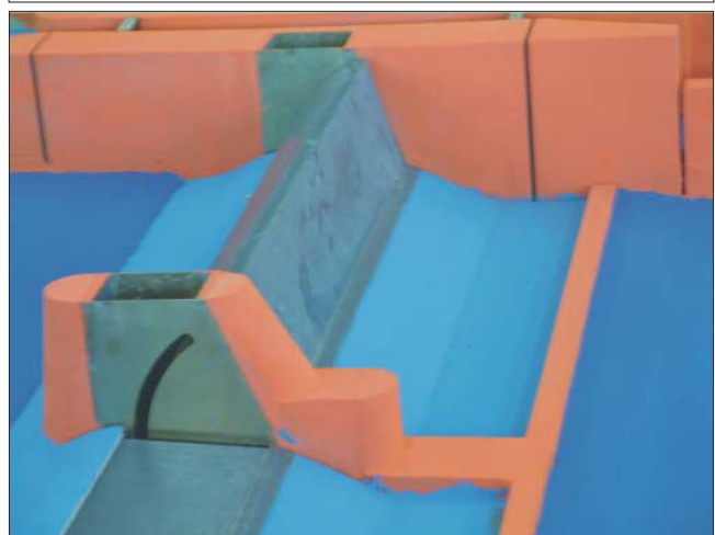
Bild 22: Wehranlage Grevenmacher – Werkstattzeichnung und eingebauter Modellwehrcörper
