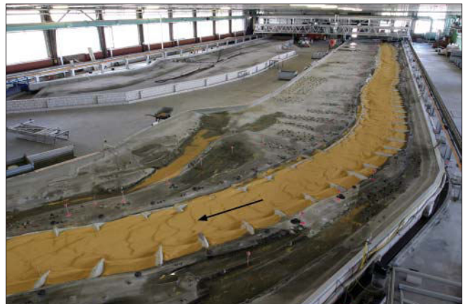
Bild 2: Hydraulisches Modell der Oder bei Hohenwutzen (MdL: 1:100, L = 78 m)
