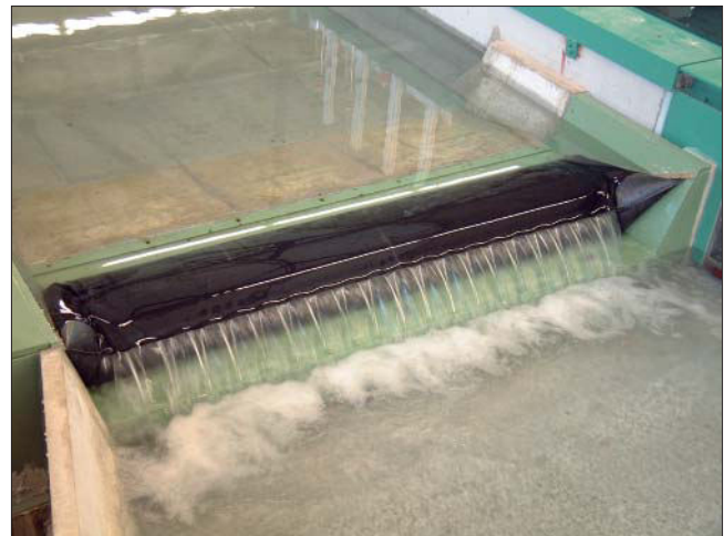
Bild 19: Wassergefülltes Modellschlauchwehr bei Überströmung, M 1 : 12,5
