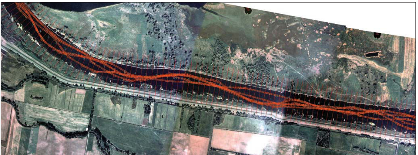
Bild 35: Fahrrinnen aus fünf unabhängigen Sohlgeometrien im Modell (V0)
