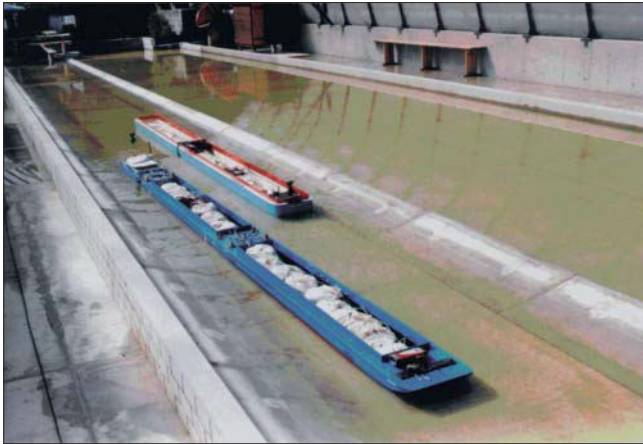
Bild 5: Begegnungsfahrt zweier Schubverbände im Standard-Trapez-Profil
