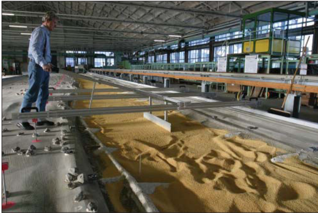
Bild 11: Einebnen der Modellsohle
