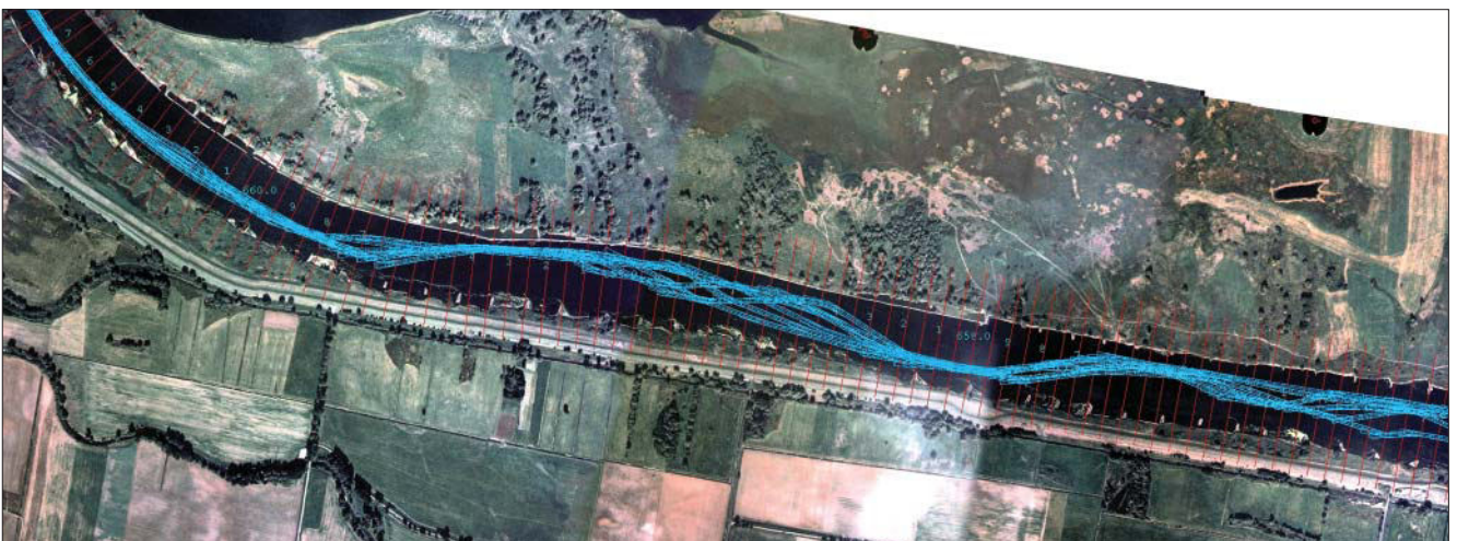
Bild 36: Fahrrinnen bei einer Untersuchungsvariante (Buhnenvariante)
