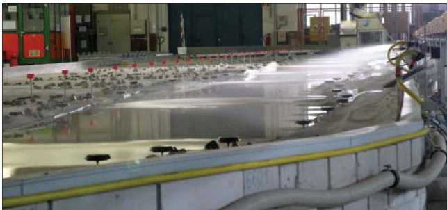
Bild 12: Beregnen des Modells während des Füllvorganges
