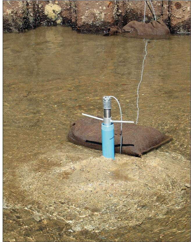
Bild 8 Messsystem bestehend aus Datenlogger und Packer (links) und eingebautes Messsystem (rechts)
