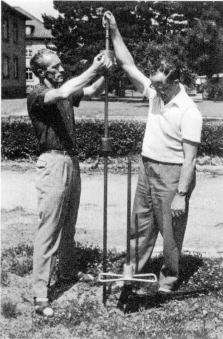
Abb. 2a Leichte Rammsonde der BAW
