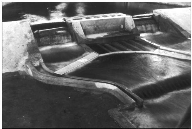
Bild 21: Talsperre Spremberg/Spree (Erdamm), Modell der Hochwasserentlastung und der Grundablässe
