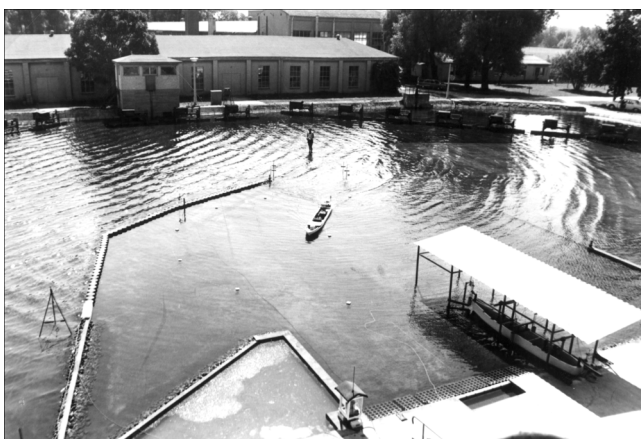
Bild 15: Modell des Fährhafens Mukran mit Wellenauf- lauf aus Nordost und Einfahrt eines ferngesteuerten Fährschiffsmodells
