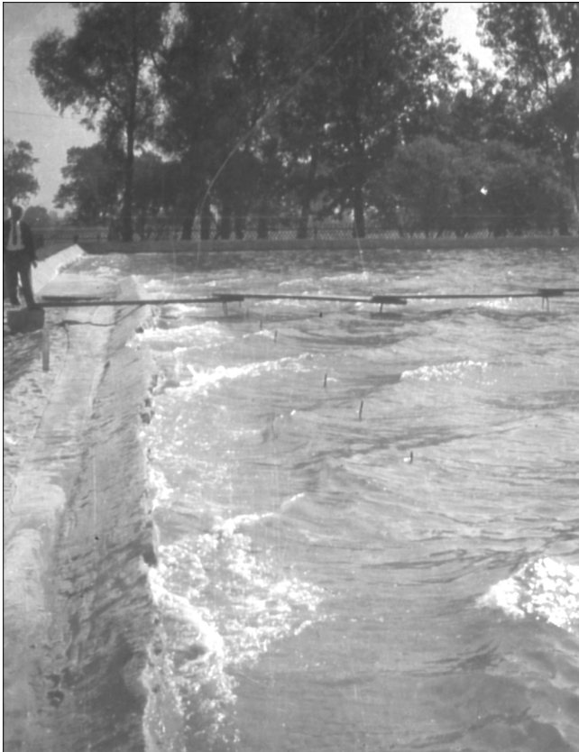
Bild 18: Dreidimensionales Modell eines Küstenabschnittes an der Ostsee, brechende Wellen bei Auflauf auf Sandstrand mit Kliffbildung
