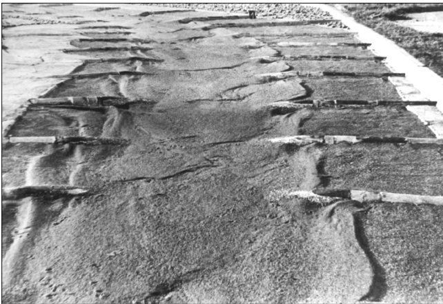
Bild 19: Modell eines mit Bühnen regulierten Abschnittes der Oder mit natürlich umgebildeter beweglicher Sohle
