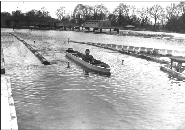
Bild 14: Einfahrt eines freifahrenden personengesteuerten Modellschiffes in den Seekanal
