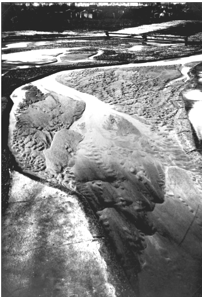
Bild 1: Modellversuche für den Wolga-Don-Kanal, Umbildung der beweglichen Sohle des Modellflusses
