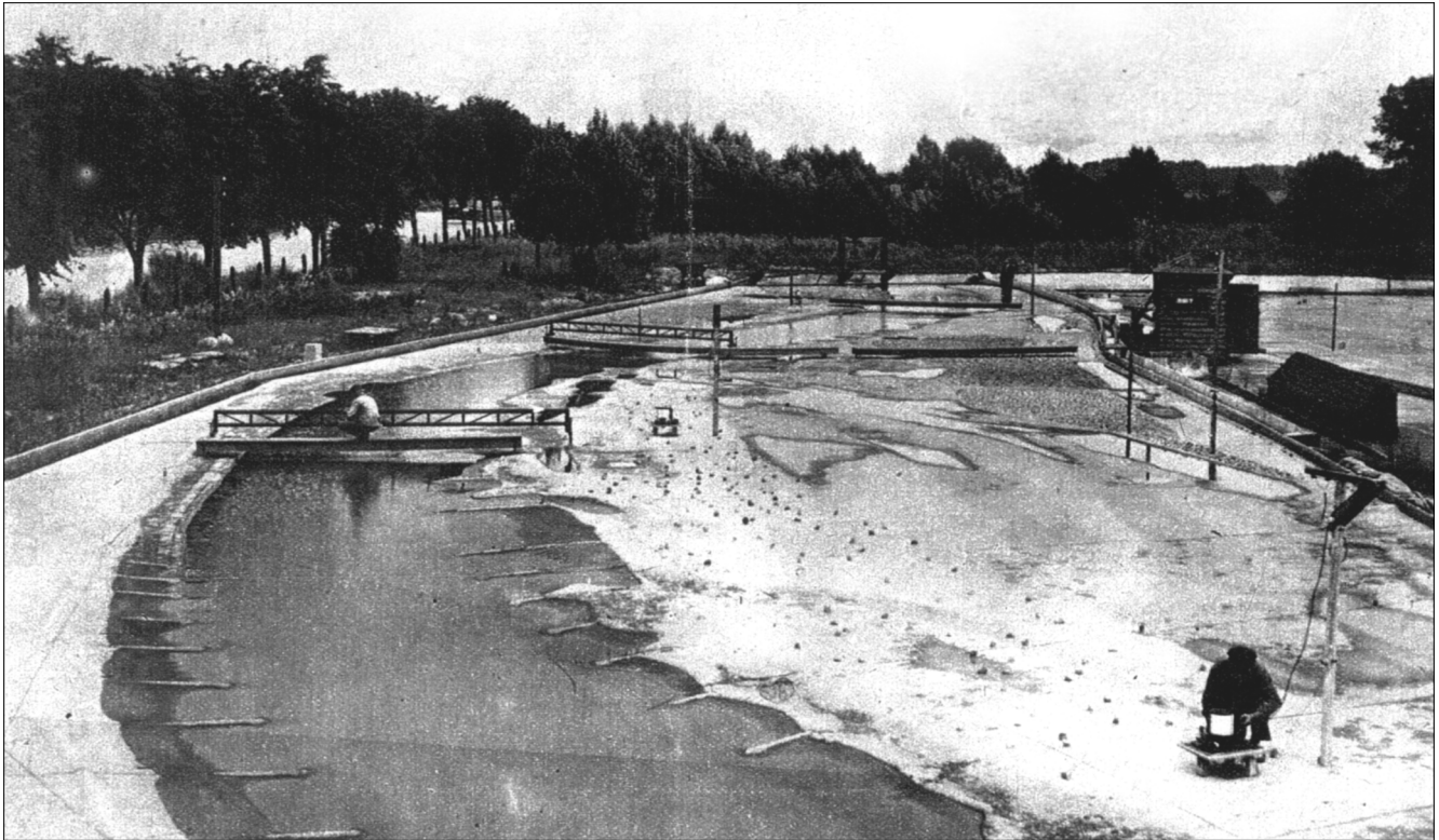
Bild 2: Modell der Elbe bei Schönebeck, Maßstab 1:50 (Quelle: holländische Zeitschrift, um 1935) „Wasserbauliche Untersuchungen auf originelle Weise“
