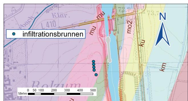
Bild 11: Lage der Infiltrationsbrunnen zur Abwehr des Zustroms aus südlichen Bereichen
