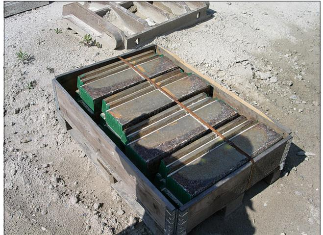
Bild 4: Verschleißteile des Prallbrechers
