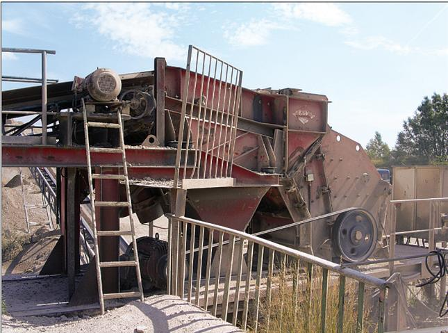
Bild 3: Prallbrecher zur Aufbereitung
