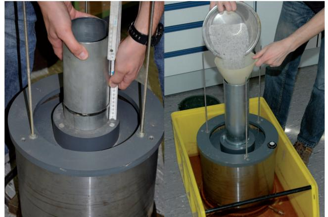
Bild 7: Ziehen des Ausstechzylinders (links) und Einfüllen des Sandes (rechts)
