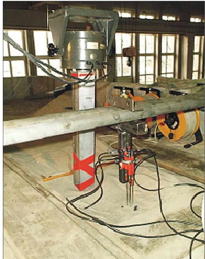
Bild 3: Vibrationsrammung einer Modellbohle im Nahbereich des Messfeldes mit Schwingungs- und Setzungssensoren in einem Sandlager
