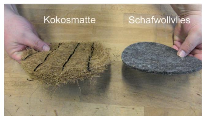
Bild 8: Verschiedene Filtermatten für pflanzliche Ufersicherungen
