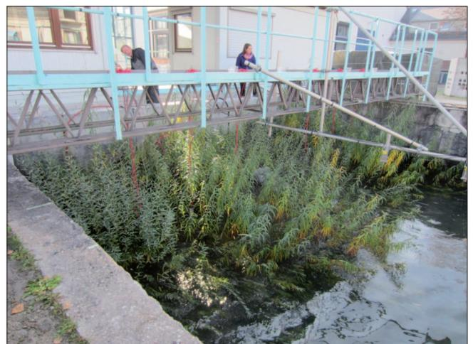
Bild 19: Modellversuch am 28. Oktober 2011: Weiden-spreitlagen, 5 Monate nach Einbau
