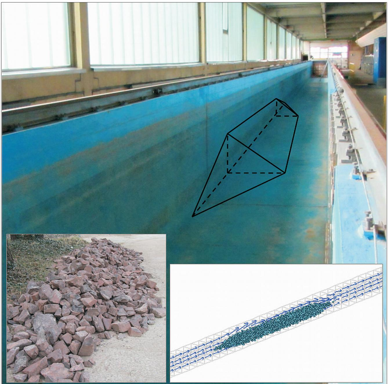
Bild 6: Modellversuche: Strömungsrinne mit geplantem Deckwerksabschnitt, Deckwerkssteine CP90/250 und numerische Modellierung
