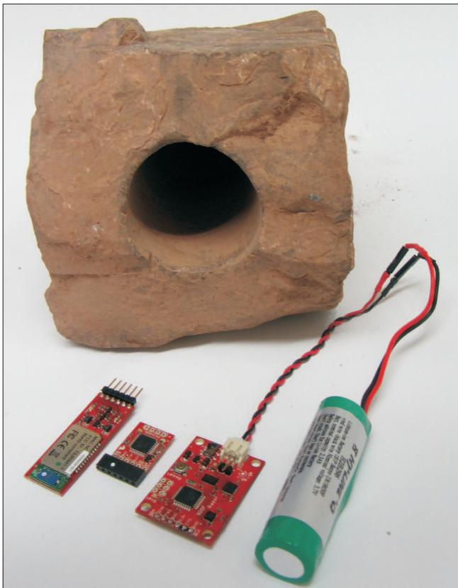
Bild 7: Deckwerksstein und Beschleunigungsaufnehmer
