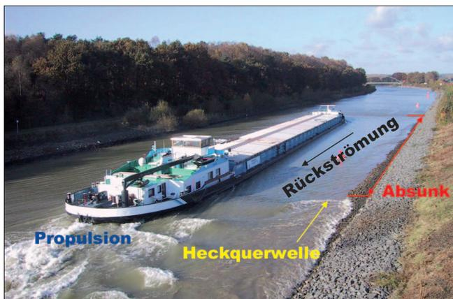
Bild 1: Schiffsinduzierte hydraulische Belastungen im begrenzten Wasserquerschnitt
