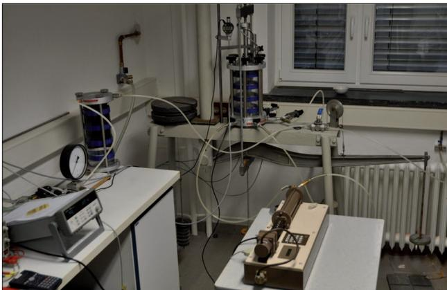
Bild 5: Lastgesteuertes Triaxialgerät am Institut für Geotechnik der Technischen Universität Dresden
