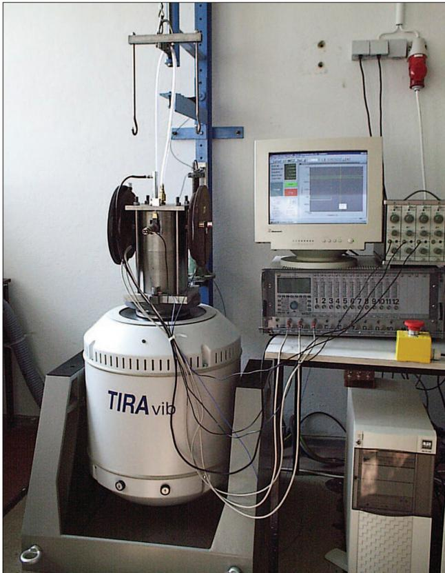
Bild 2: Dynamisches Ödometer
