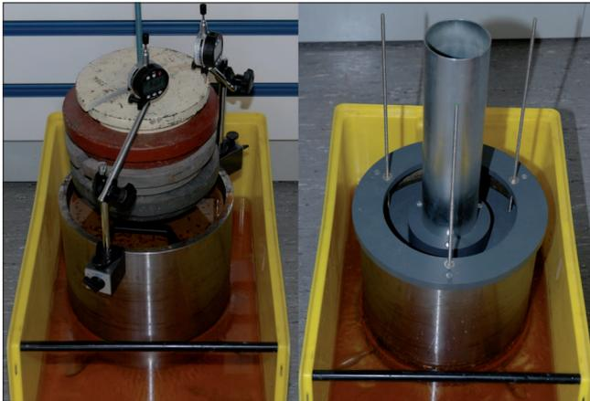
Bild 6: Vorkonsolidation des weichen Bodens (links), Haltevorrichtung für Ausstechzylinder (rechts)
