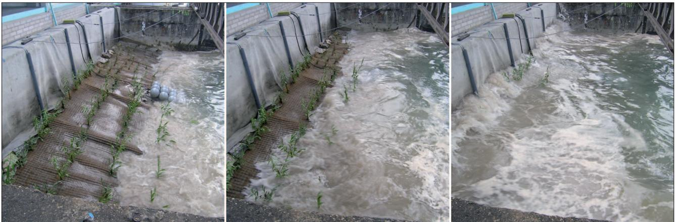
Bild 18: Modellversuch am 10. Juni 2010: Böschungsschutzmatte mit Steckhölzern
