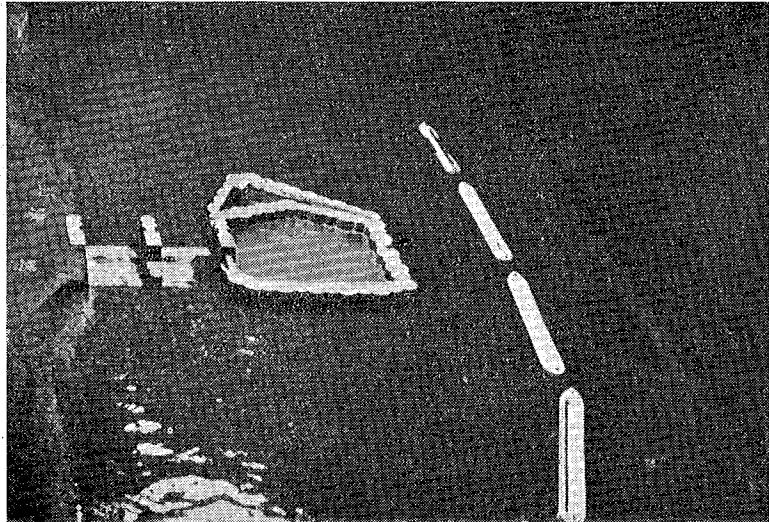
Abb. 4. Modellversuch zur Ermittlung der günstigsten Baugrubenform.
