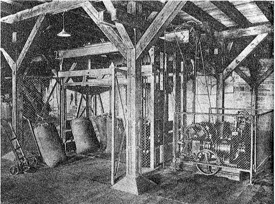
**Bild 19: Elektrischer Aufzug im Getreidelagerhaus**
