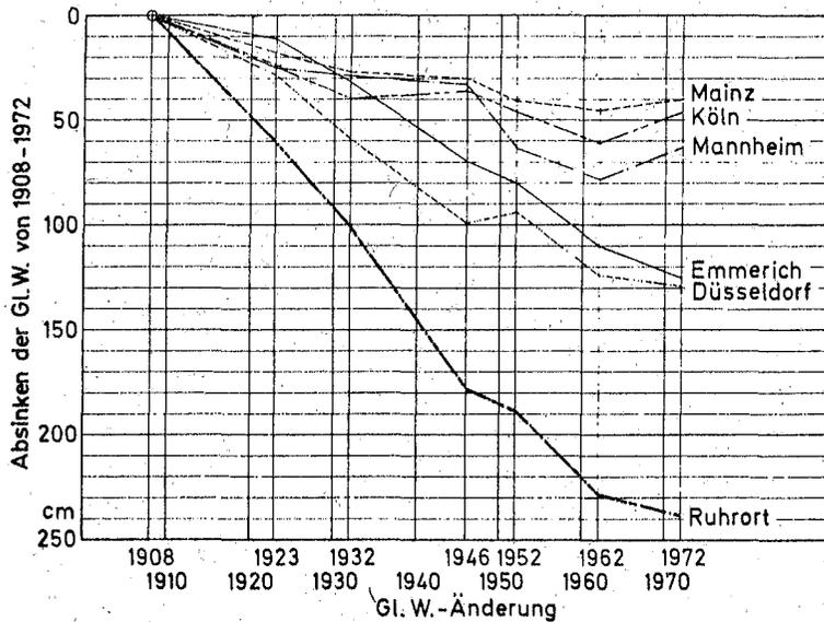
**Bild 10: Entwicklung des Gleichwertigen Wasserstandes an den Richtpegeln des Rheins**
