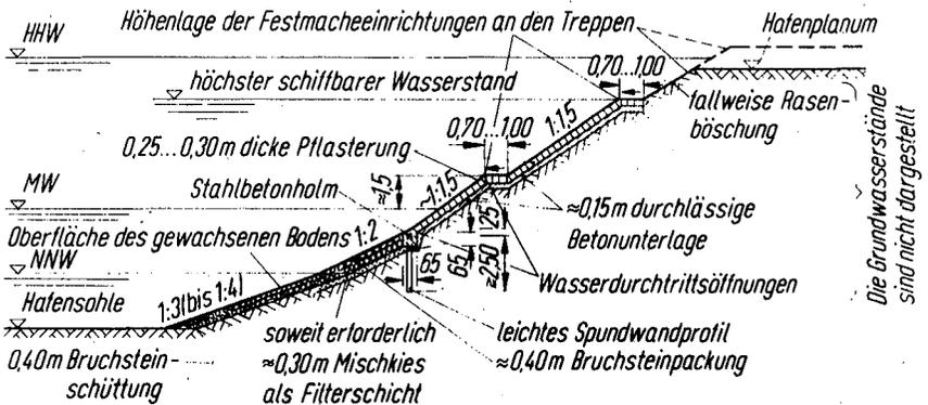
**Bild 6: Böschungsufer**
