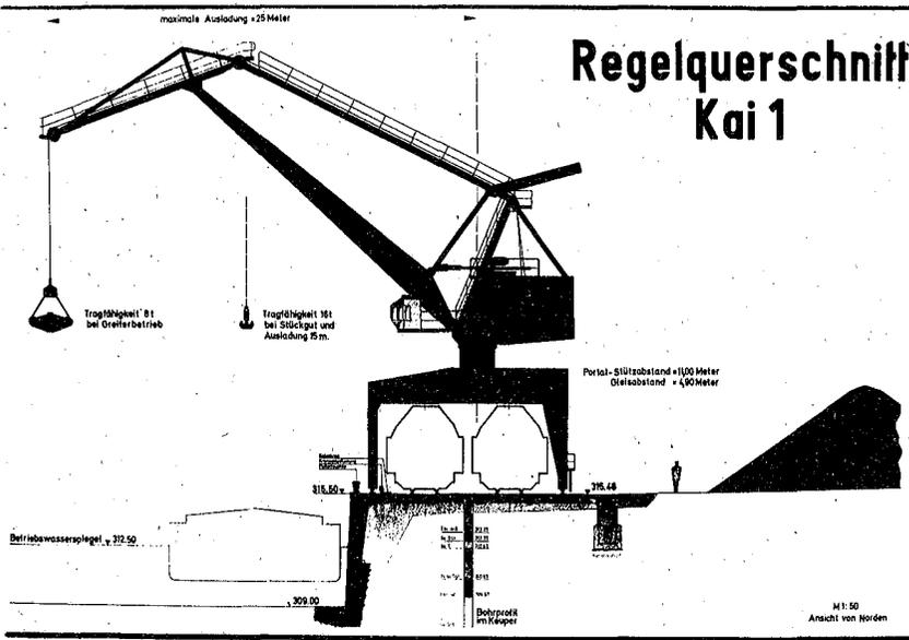
**Bild 44: Regelquerschnitt Kai 1.**
