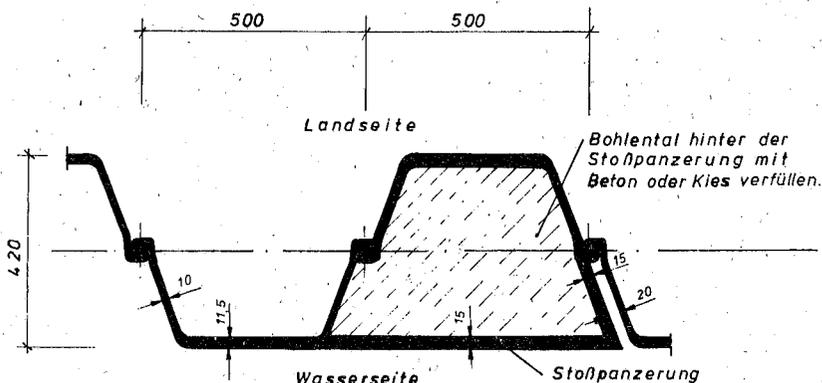
Bild 14: Gepanzerte Spundwand
