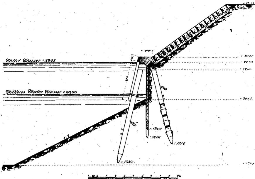
**Bild 7: Böschung mit Betonbohlwerk im Querschnitt**
