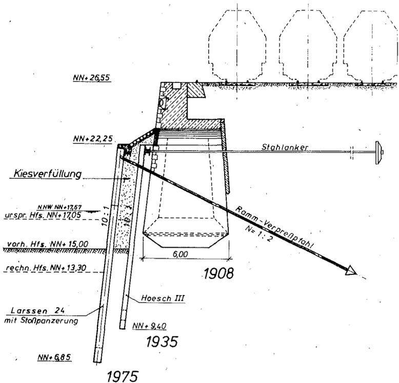
**Bild 13: Ufermauer mit doppelter Spundwandsicherung
