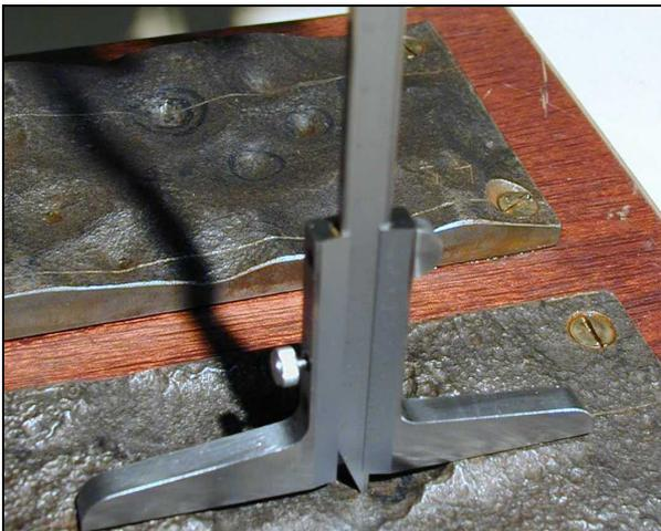
**Bild 4:** Muldentiefen-Messung mittels Schieblehre
