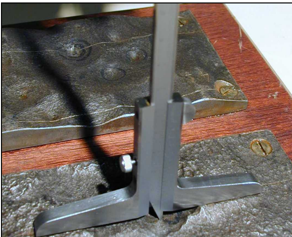
Bild 4: Muldentiefen-Messung mittels Schieblehre
