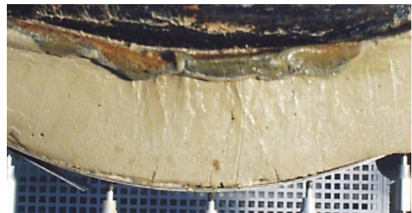
Bild 5: Colcredur im Biegeversuch
