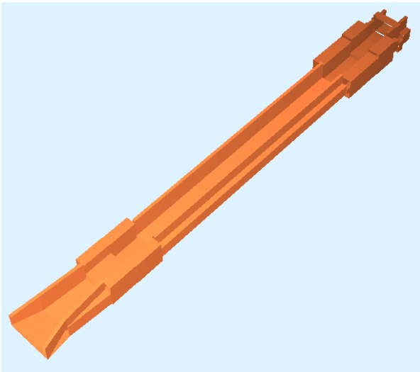
Bild 3: Gesamtmodell der Schleuse mit veränderlichen Querschnitten
